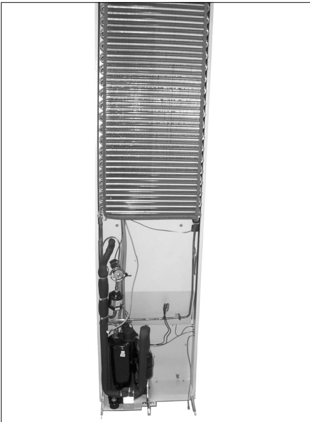
Abb. 81: Wärmetauschregister und Kompressorraum mit Druckluft ausblasen (1)
