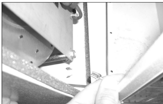
Abb. 57: Erdungskabel zwischen Haube und Chassis lösen (2)
