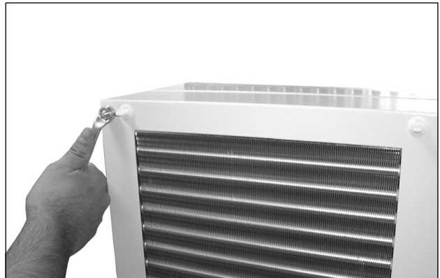
Abb. 51: Haube abmontieren (vier Schrauben lösen)
