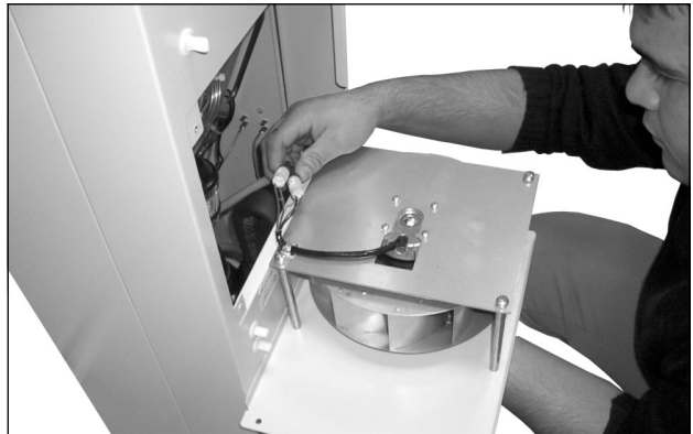
Abb. 72: Steckverbindungen des Lüfters abziehen (1)
