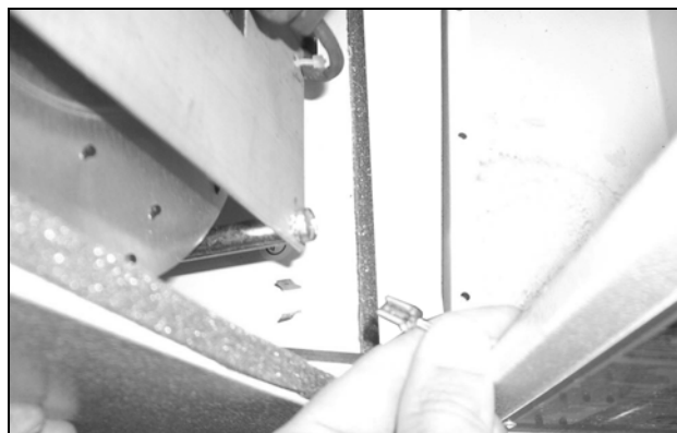
Obr. 57: Odpojení uzemňovacího kabelu mezi krytem a podstavcem (2)
