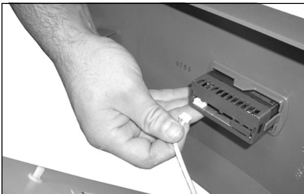
Obr. 67: Vytažení kabelu displeje
