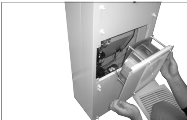
Obr. 71: Demontáž ventilátoru vnějšího okruhu
