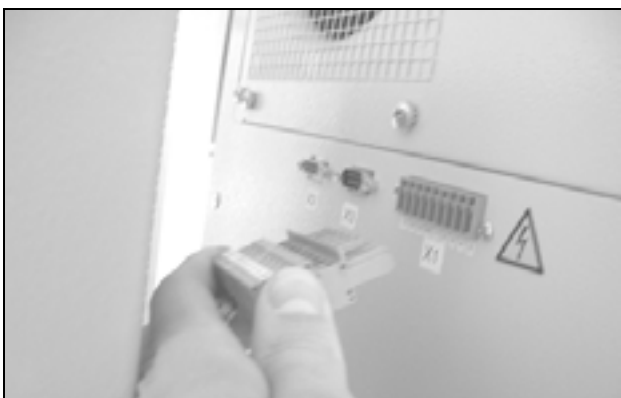
Obr. 60: Vytažení síťové zástrčky
