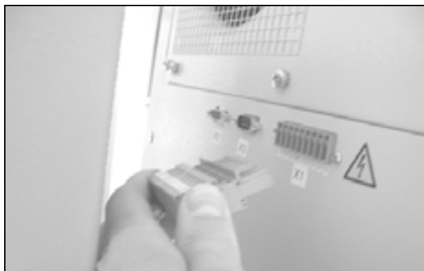
Obr. 41: Vytažení síťové zástrčky
