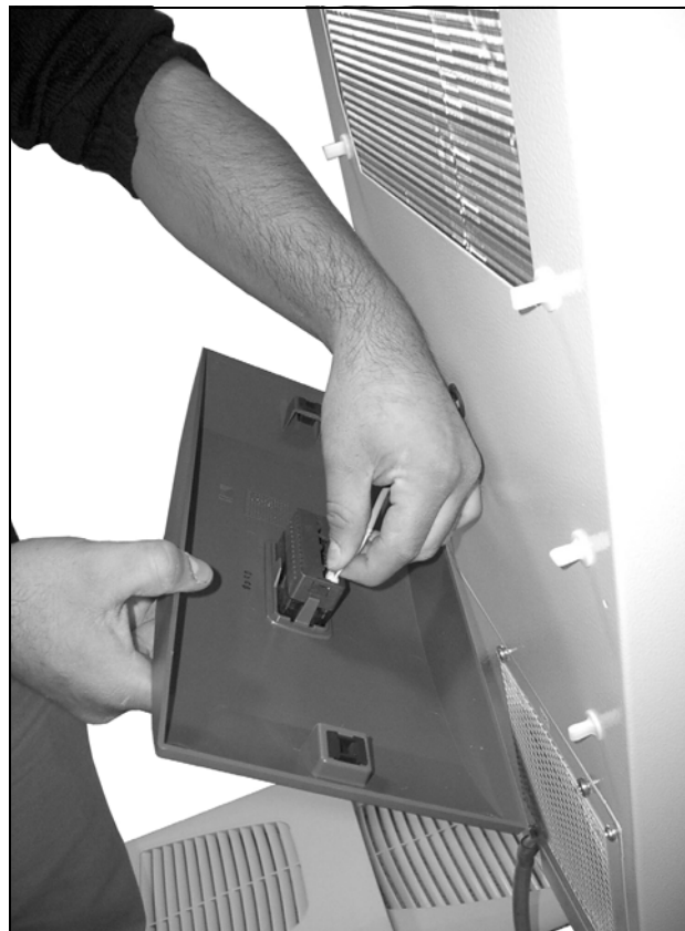
Obr. 45: Vytažení zástrčky z displeje (1)
