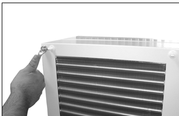
Obr. 51: Demontáž krytu (povolit čtyři šrouby)
