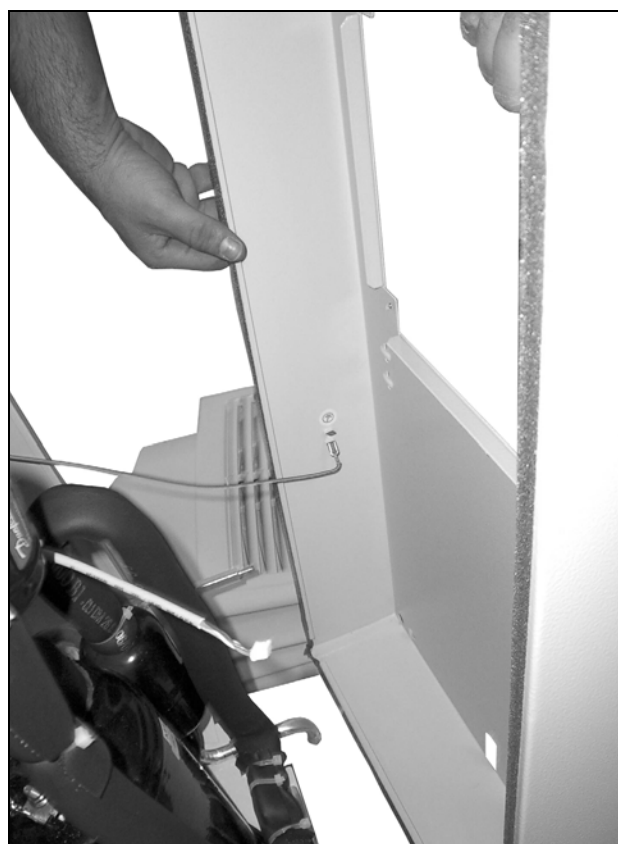
Obr. 79: Vytažení uzemňovacího kabelu (1)
