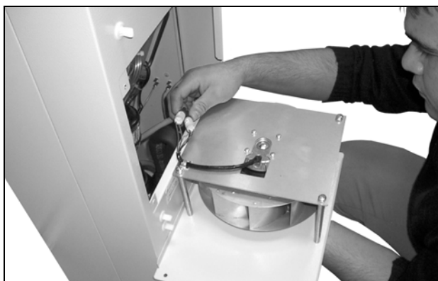
Obr. 72: Vytažení zásuvek ventilátoru (1)
