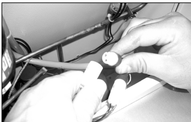
Obr. 74: Vytažení zásuvek ventilátoru (3)
