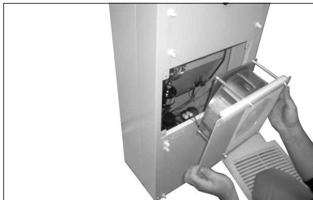
Fig. 71: Det eksterne kredsløbs ventilator afmonteres
