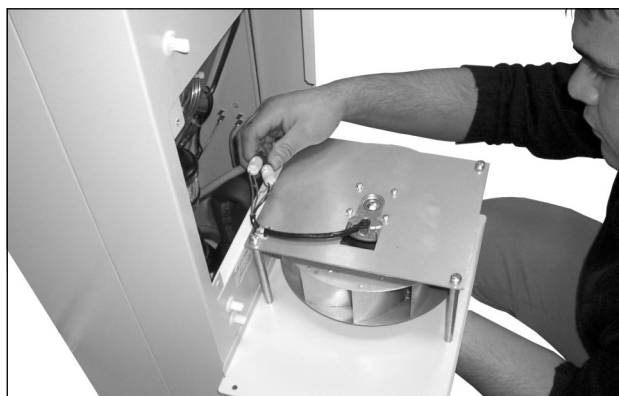
Fig. 72: Ventilatorens stikforbindelser trækkes af (1)
