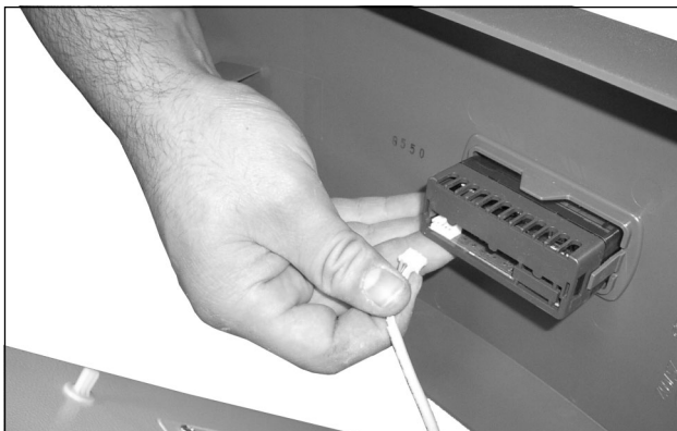
Fig. 67: Displaykabel trækkes af
