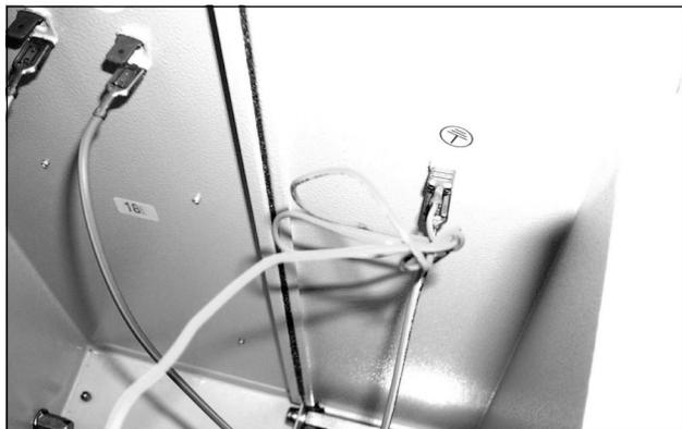
Imagen 75: Desconectar el cable de puesta a tierra del ventilador (1)
