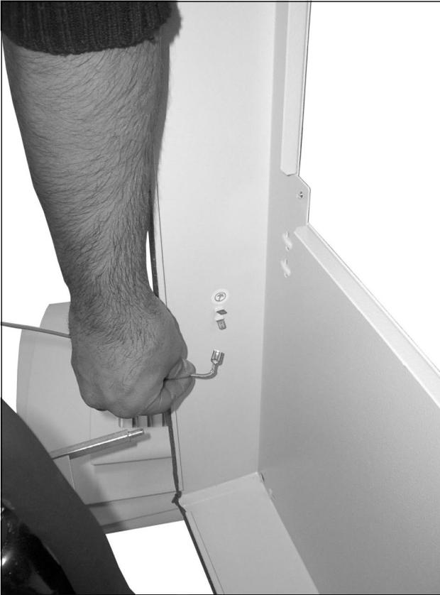
Imagen 80: Desconectar el cable de puesta a tierra (2)
