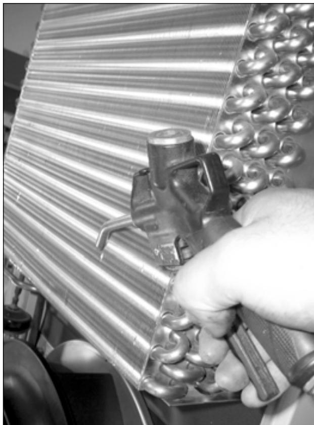
Imagen 58: Aplicar aire a presión en el registro del intercambiador de calor y el espacio del compresor (1)
