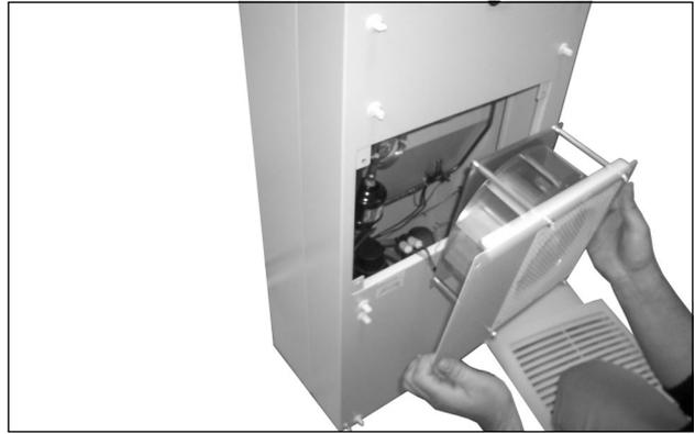
Imagen 71: Desmontar el ventilador del circuito exterior
