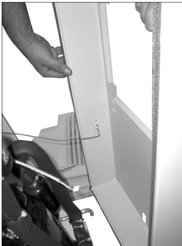
Imagen 79: Desconectar el cable de puesta a tierra (1)
