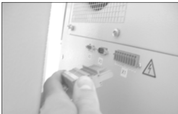
Fig. 60 : Couper l'alimentation en débranchant la fiche
