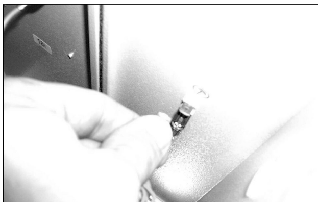
Fig. 76 : Retirer le câble de mise à la masse du ventilateur (2)
