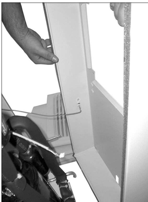
Fig. 79 : Retirer le câble de mise à la masse (1)
