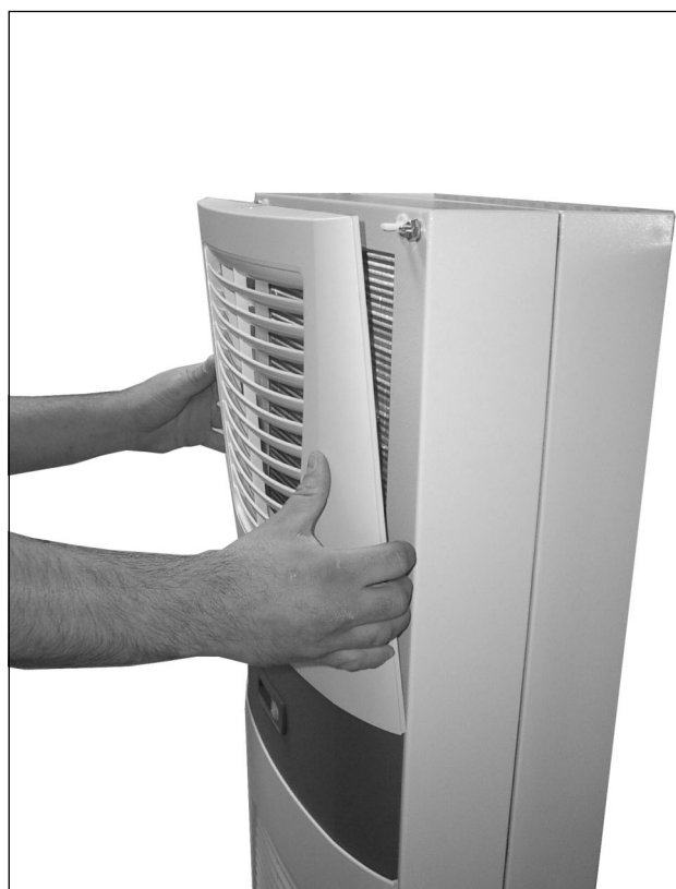
Fig. 42 : Retirer la grille à lamelles supérieure
