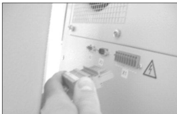
Fig. 41 : Couper l'alimentation en débranchant la fiche
