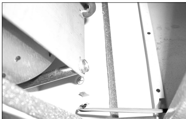
Fig. 56 : Retirer le câble de mise à la terre qui se trouve entre le capot et le châssis (1)
