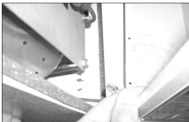
Fig. 57 : Retirer le câble de mise à la terre qui se trouve entre le capot et le châssis (2)
