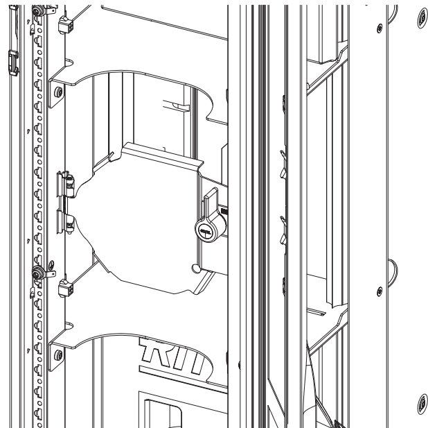
Abb. 57: Einsetzen der Lüftertür
