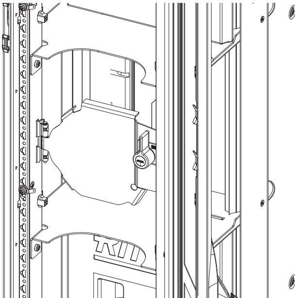
Fig. 57: Placing the fan door
