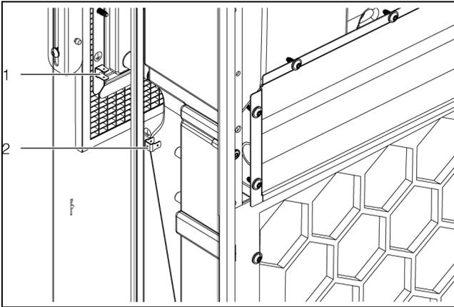
Imagen 36: Conexión del conector fusible (visto desde atrás)
