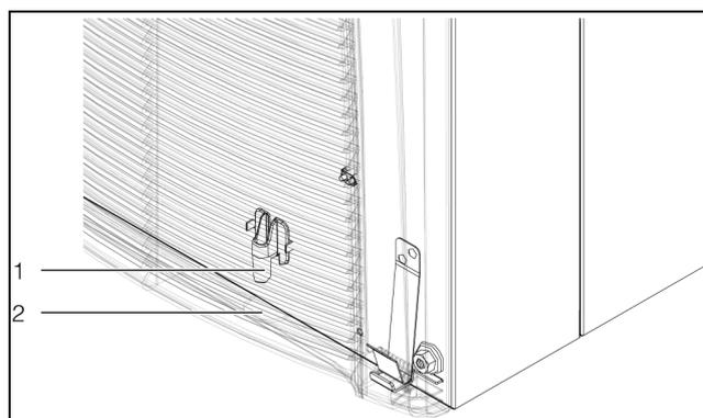
Imagen 12: Conexión para tubo desagüe de condensación
