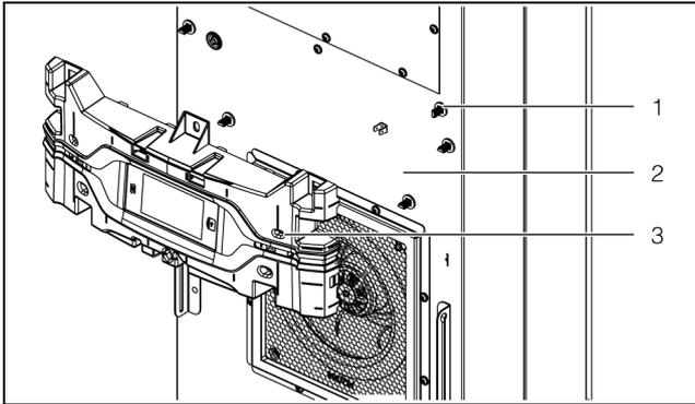
Imagen 32: Desmontaje del embellecedor (imagen de ejemplo)
