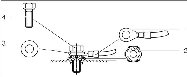
Imagen 16: Ejecución de la compensación de potencial
