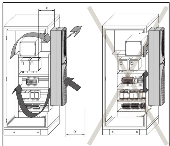
Imagen 5: Circulación del aire en el armario
