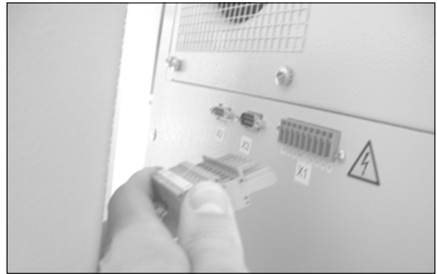
図 41： 接続プラグを抜く
