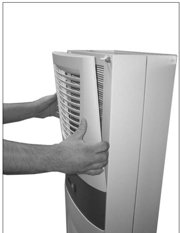
図 42： 上のプラスチックルーバーを取外す
