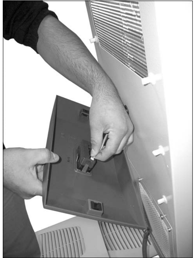
図 45： モニターのプラグを抜く (1)
