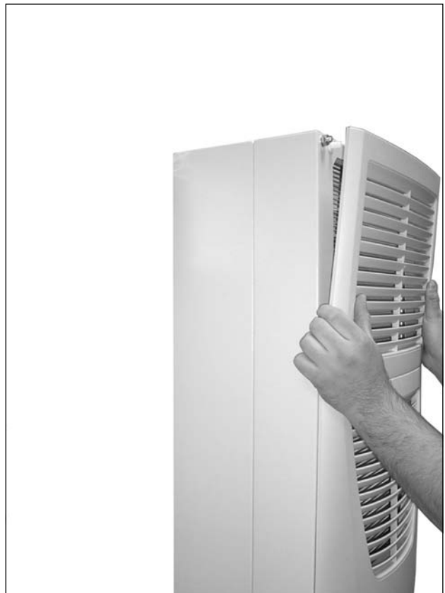
図 62： 上のプラスチックルーバーを取外す (2)
