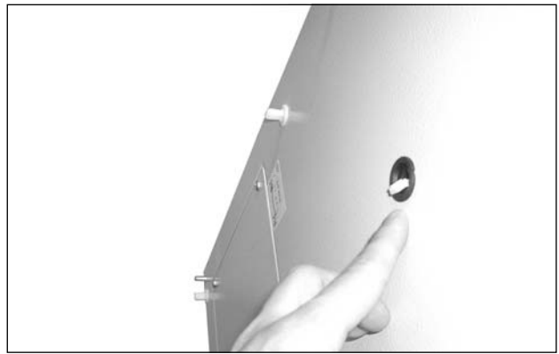
図 53：モニターケーブルをケーブルの引込み口に押し込む
