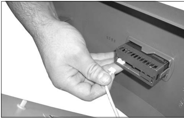
図 67： モニターケーブルを引き抜く
