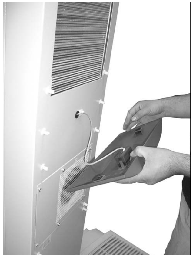
図 66： ベルト部を取外す
