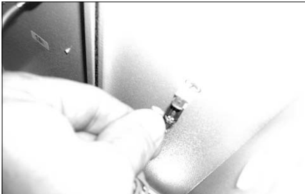
図 76： ファンのアースケーブルを外す (2)
