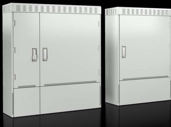
Coffret à double paroi en aluminium pour l'implantation en extérieur avec une classe de résistance RC 2 et socle de rangement des câbles. Conçu pour recevoir des rails combinés 19"/ETSI et un système Direct Air Cooling (DAC).
