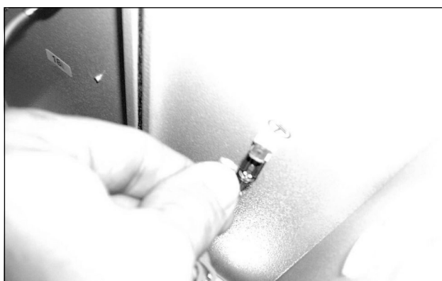
Afb. 76: Aardingskabel van de ventilator losnemen (2)
