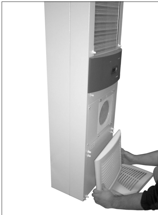
Afb. 65: Onderste ventilatierooster verwijderen (2)
