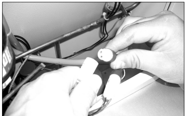
Afb. 74: Connectoren van de ventilator losnemen (3)
