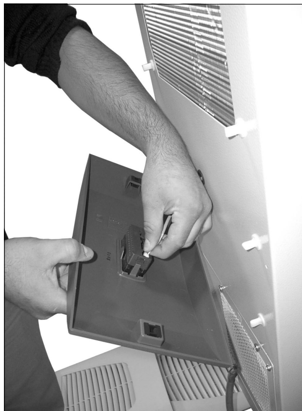
Afb. 45: Connector van het display losnemen (1)
