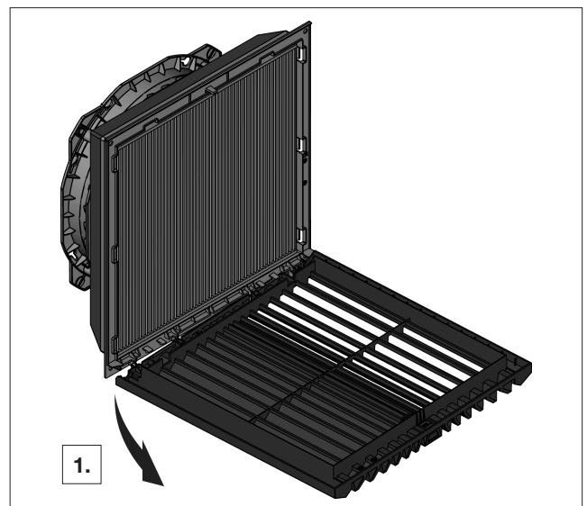
Abb. 5: Linke Scharnierseite des Lamellengitters lösen (3239.xxx bis 3244.xxx)
