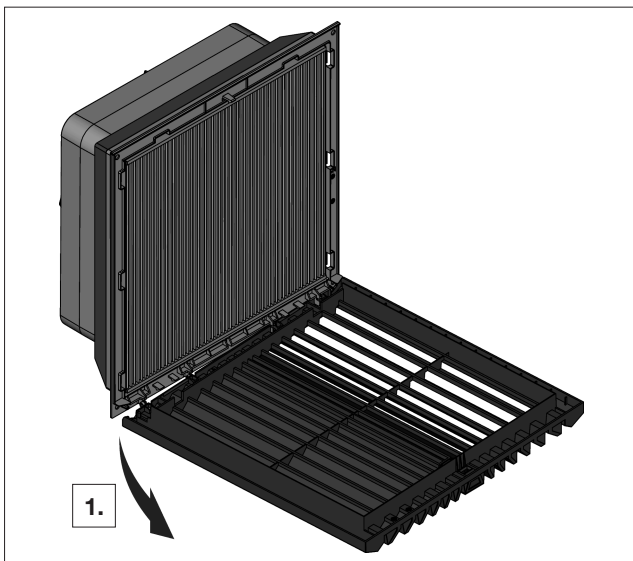
Abb. 3: Linke Scharnierseite des Lamellengitters lösen
