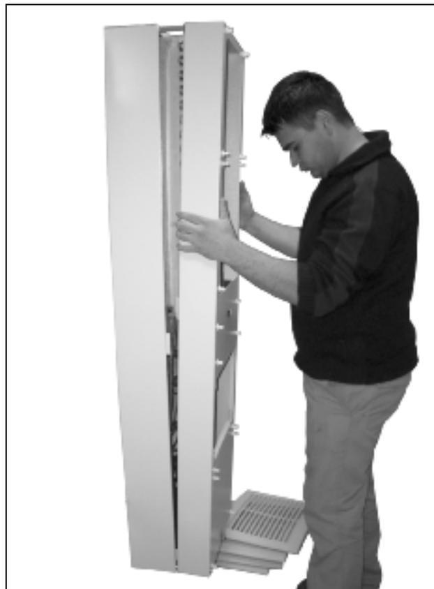
Рис. 78: Снятие кожуха
