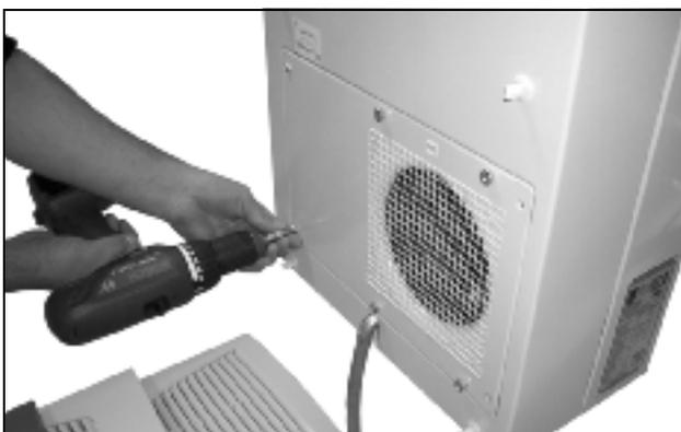
Рис. 48: Демонтаж вентилятора внешнего контура (отвинтить четыре винта)
