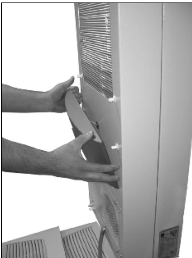
Рис. 44: Снятие средней панели
