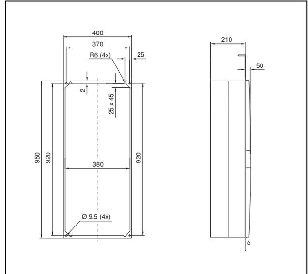
Рис. 106: SK 3304.xxx, SK 3305.xxx утепленный монтаж
