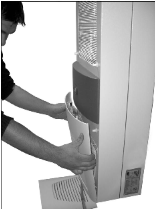
Рис. 43: Снятие нижней вентиляционной решетки
