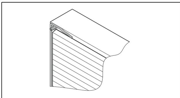
Рис. 12: Наклеивание уплотнительной ленты
