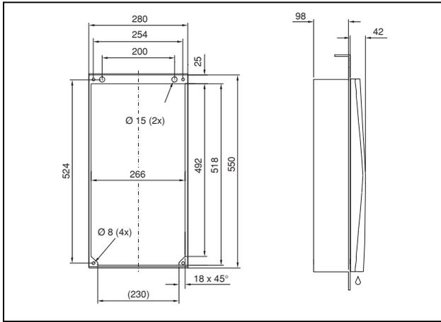
Рис. 103: SK 3302.1xx утепленный монтаж
