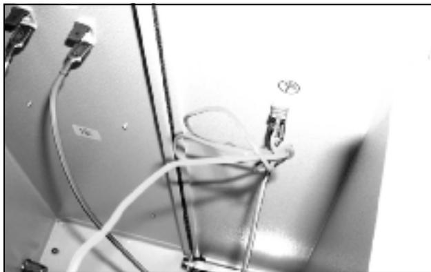
Рис. 75: Отсоединение кабеля заземления вентилятора (1)
