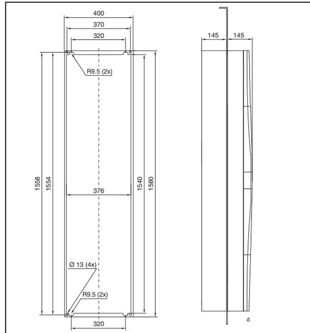
Рис. 101: SK 3328.xxx, SK 3329.xxx полутопленный монтаж
