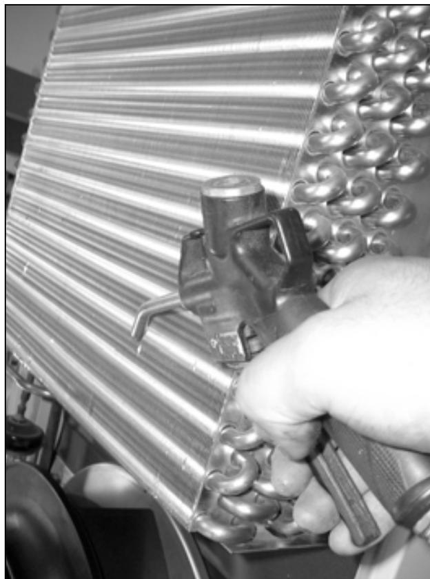
Рис. 58: Продувка теплообменного элемента и компрессорного отделения сжатым воздухом (1)
