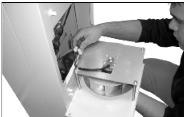
Рис. 72: Отсоединение штекеров вентилятора (1)
