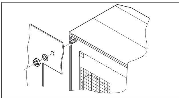
Рис. 7: Закрепление холодильного агрегата (все модели кроме SK 3302.1xx)
