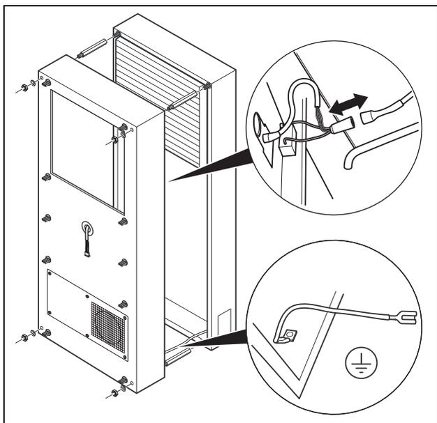
Рис. 11: Снятие кожуха
