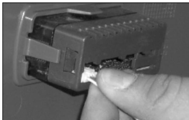
Рис. 46: Отсоединение штекера дисплея (2)
