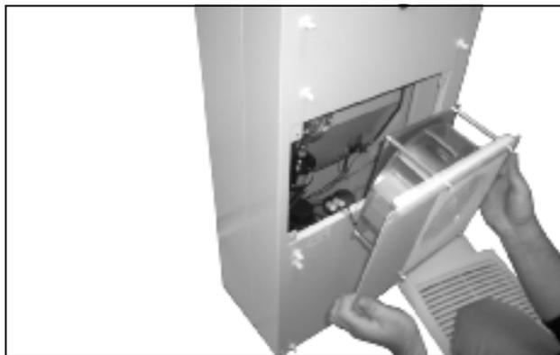
Рис. 71: Демонтаж вентилятора внешнего контура
