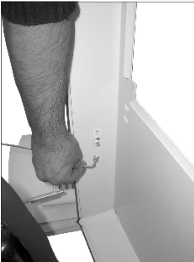
Рис. 80: Отсоединение кабеля заземления (2)
