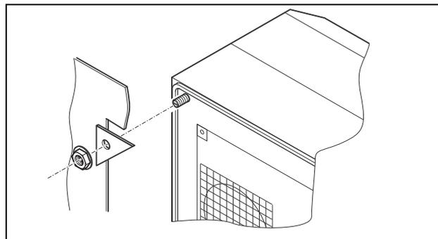
Рис. 8: Закрепление холодильного агрегата (только SK 3302.1xx «наружный монтаж»)
