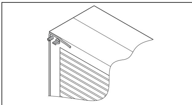
Рис. 16: Наклеивание уплотнительной ленты
