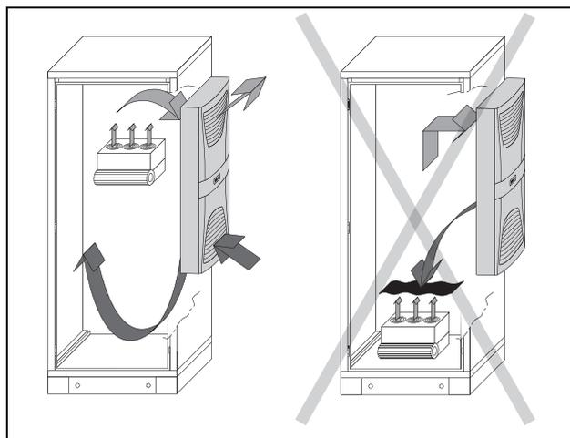
Рис. 3: Не направлять поток холодного воздуха на активное оборудование
