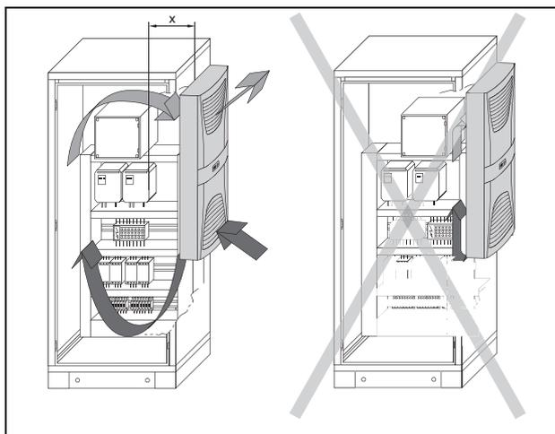
Рис. 4: Циркуляция воздуха в распределительном шкафу
