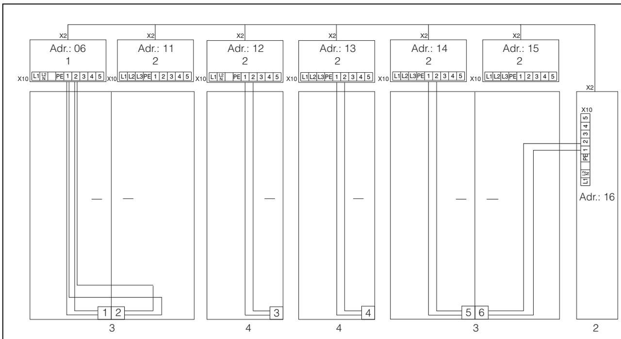
Рис. 20: Пример соединения: концевой выключатель двери и режим Master-Slave
