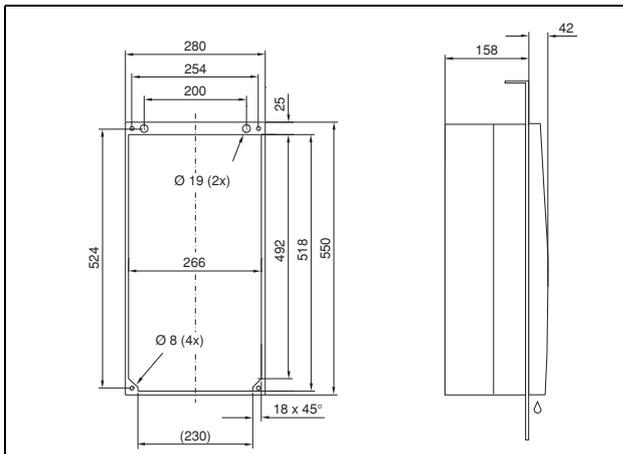
Рис. 105: SK 3303.xxx, SK 3361.xxx утепленный монтаж
