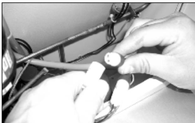
Рис. 74: Отсоединение штекеров вентилятора (3)
