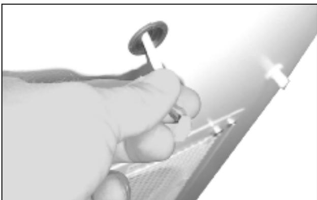
Рис. 68: Протяжка кабеля дисплея и продавливание через кабельный ввод (1)
