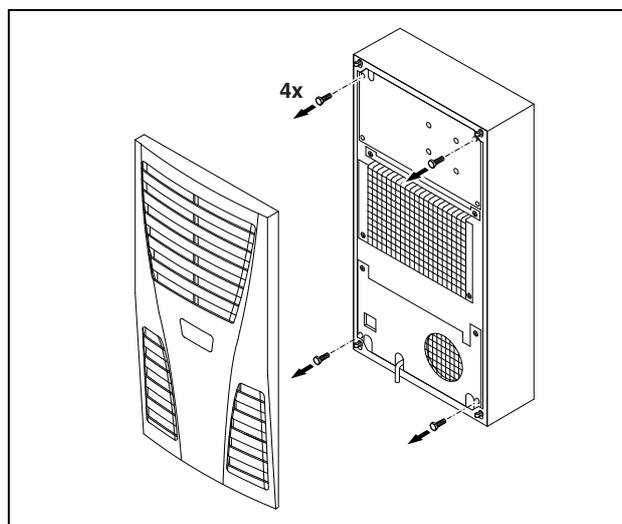
Рис. 9: Только для SK 3302.xxx: удалить четыре винта
