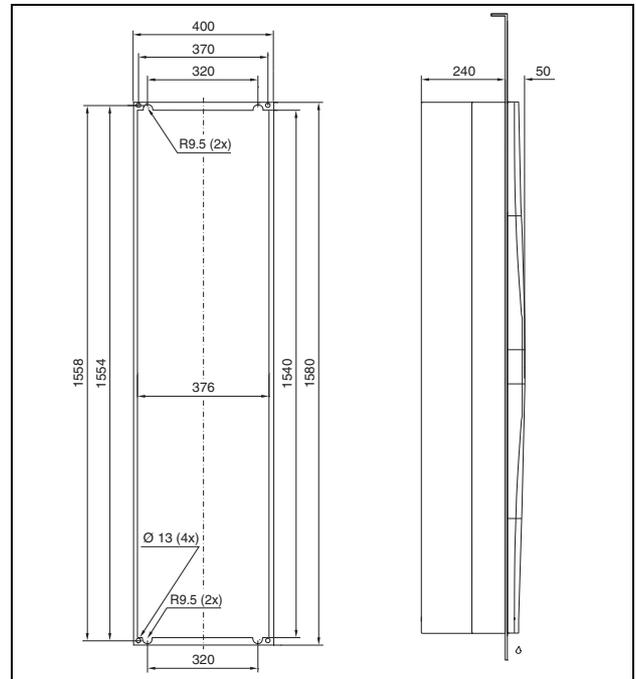
Рис. 107: SK 3328.xxx, SK 3329.xxx утепленный монтаж
