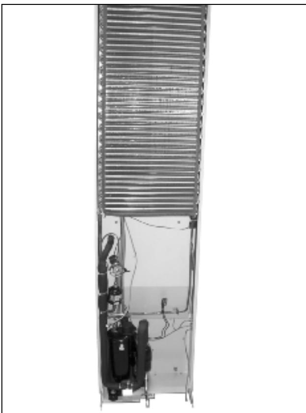
Рис. 81: Продувка теплообменного элемента и компрессорного отделения сжатым воздухом (1)
