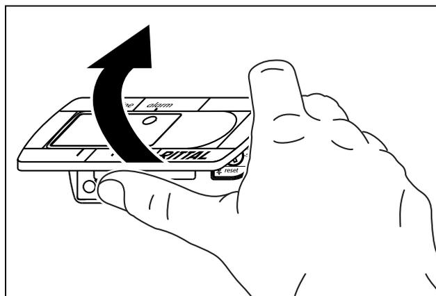
Рис. 37: Снятие панели базового контроллера
