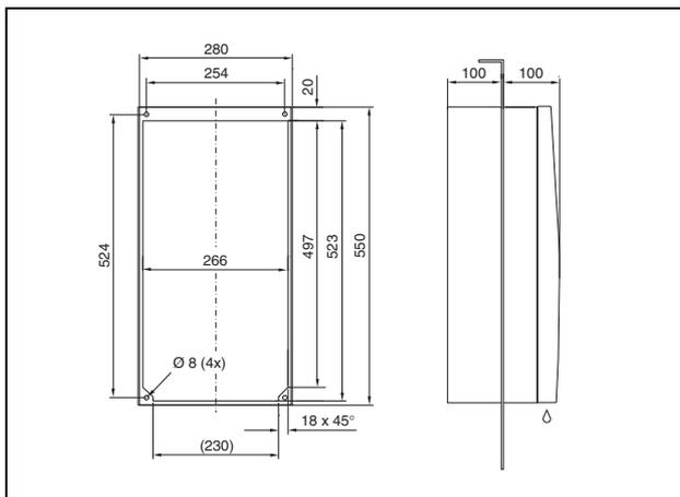
Рис. 99: SK 3303.xxx, SK 3361.xxx полутопленный монтаж
