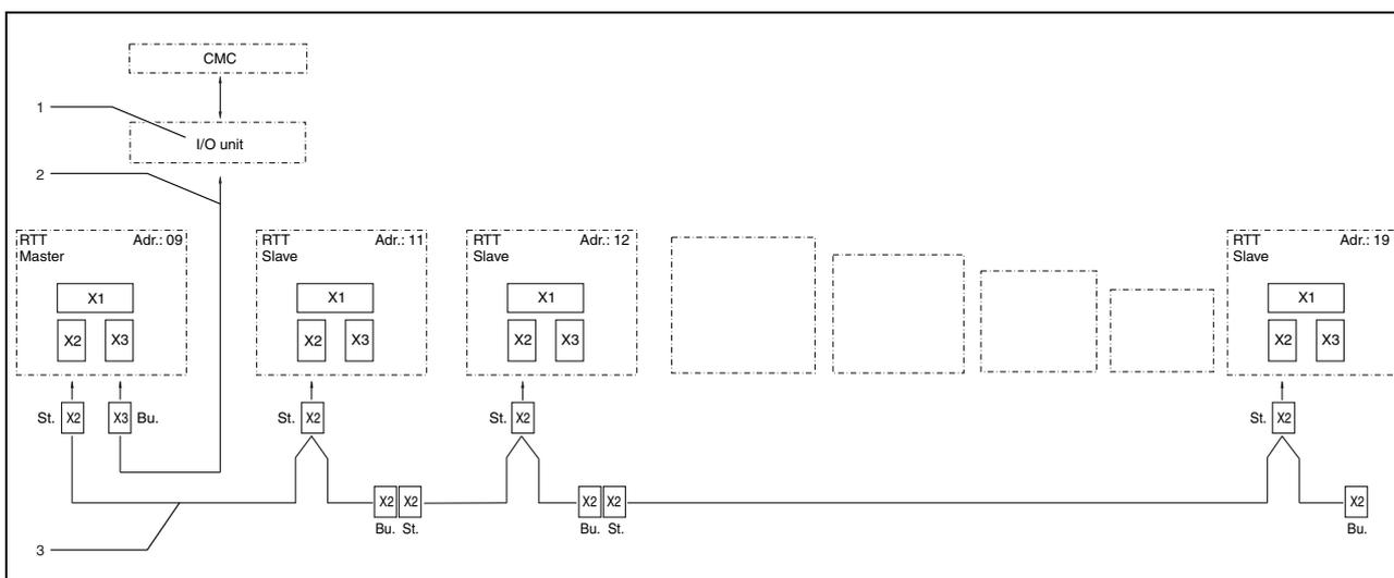
Рис. 19: Пример соединения: Master-Slave
