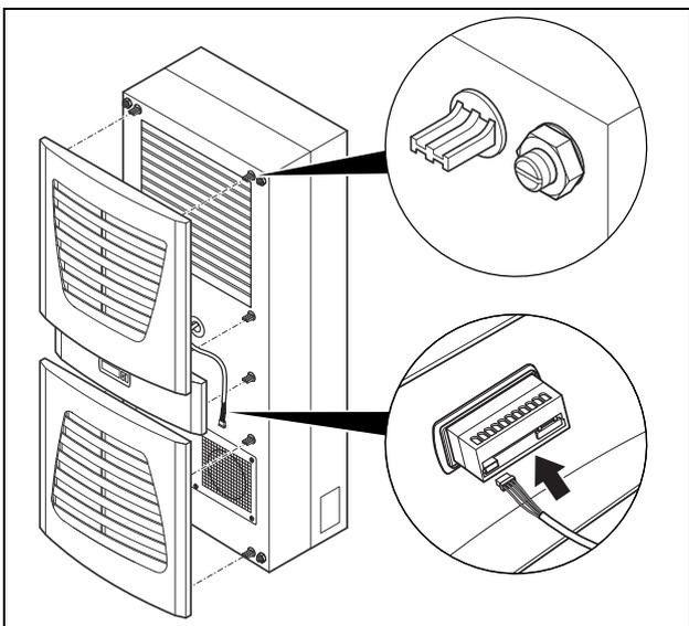
Рис. 35: Подсоединение дисплея и установка решетки
