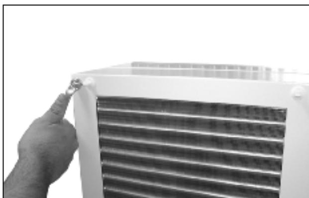
Рис. 51: Демонтаж кожуха (отвинтить четыре винта)
