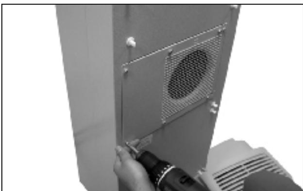
Рис. 70: Отвинчивание четырех винтов вентилятора внешнего контура
