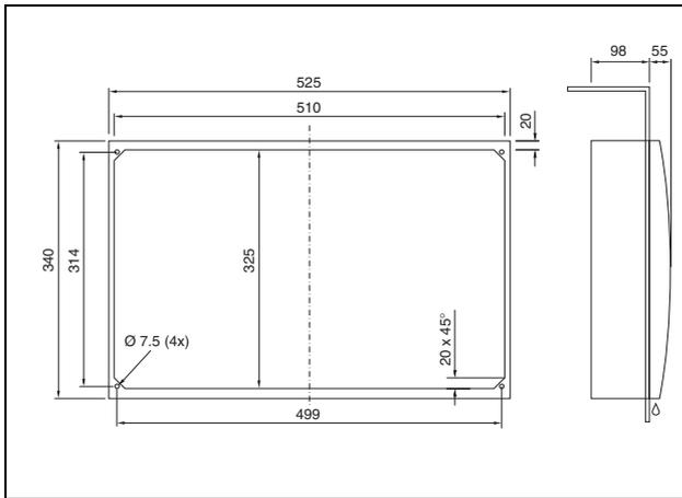
Рис. 104: SK 3302.3xx утепленный монтаж
