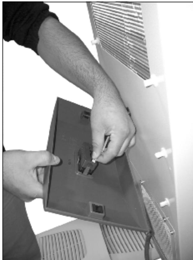
Рис. 45: Отсоединение штекера дисплея (1)
