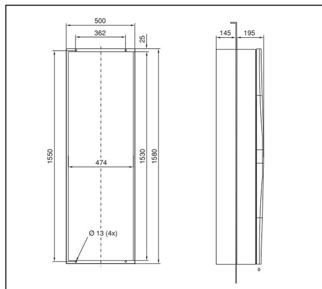
Рис. 102: SK 3332.xxx полутопленный монтаж
