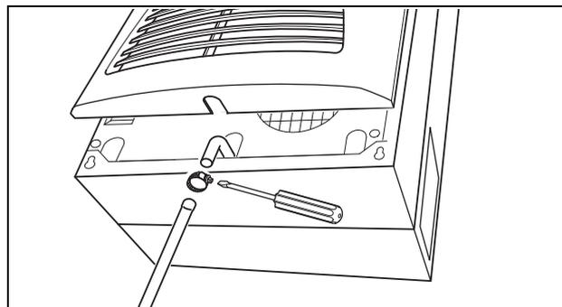
Рис. 18: Подключение отвода конденсата
