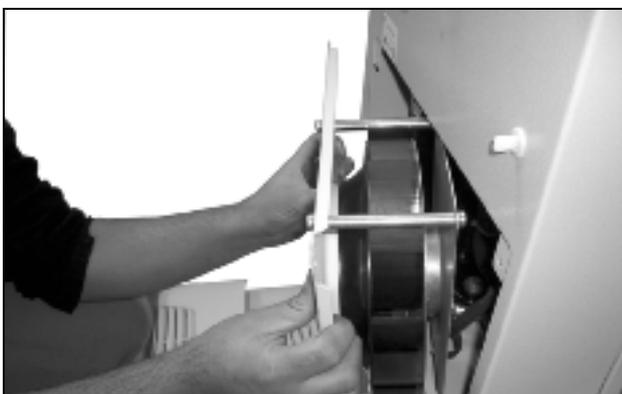
Рис. 49: Демонтаж вентилятора
