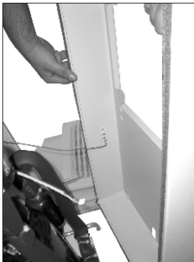
Рис. 79: Отсоединение кабеля заземления (1)
