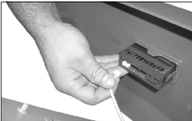
Рис. 67: Отсоединение кабеля дисплея
