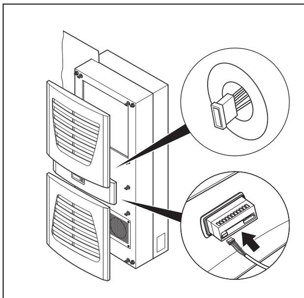
Рис. 14: Подключение штекера дисплея
