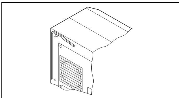
Рис. 6: Наклеивание уплотнительной ленты
