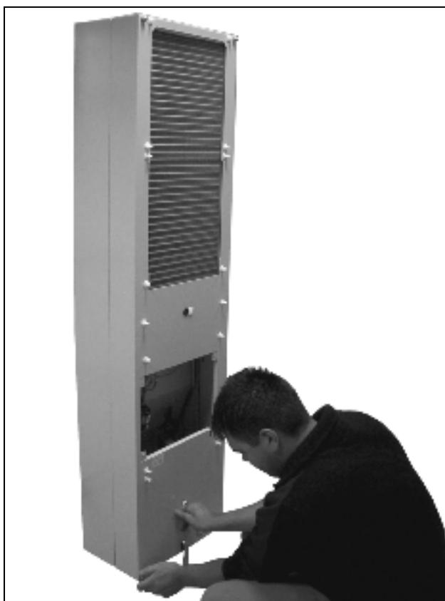
Рис. 77: Отвинчивание четырех винтов вентилятора внешнего контура
