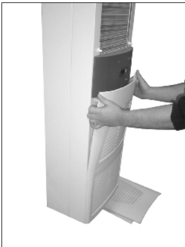
Рис. 64: Снятие нижней вентиляционной решетки (1)
