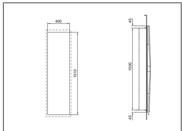
Рис. 108: SK 3366.xxx, SK 3377.xxx утепленный монтаж
