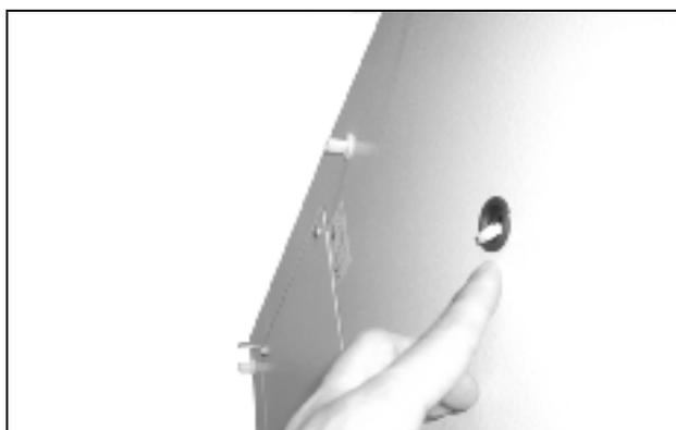
Рис. 53: Продавливание кабеля дисплея через кабельный ввод
