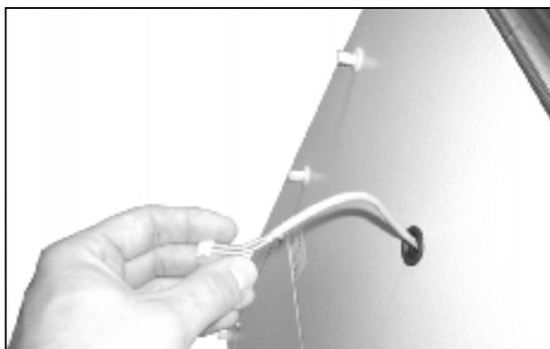
Рис. 52: Протяжка кабеля дисплея
