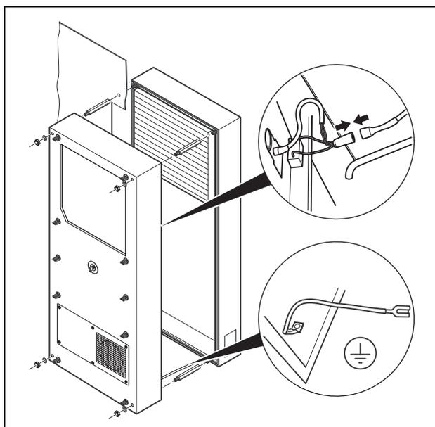
Рис. 13: Закрепление холодильного агрегата
