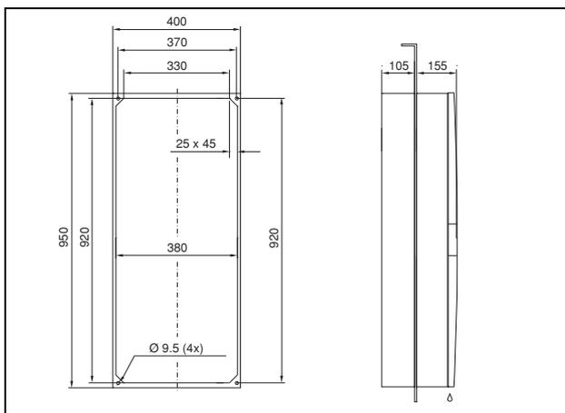
Рис. 100: SK 3304.xxx, SK 3305.xxx полутопленный монтаж
