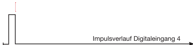
Abb.: Prinzip Impulsverlauf am Digitaleingang 4 - fallende Flanke
