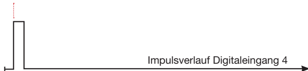
Abb.: Prinzip Impulsverlauf am Digitaleingang 4 - steigende Flanke
