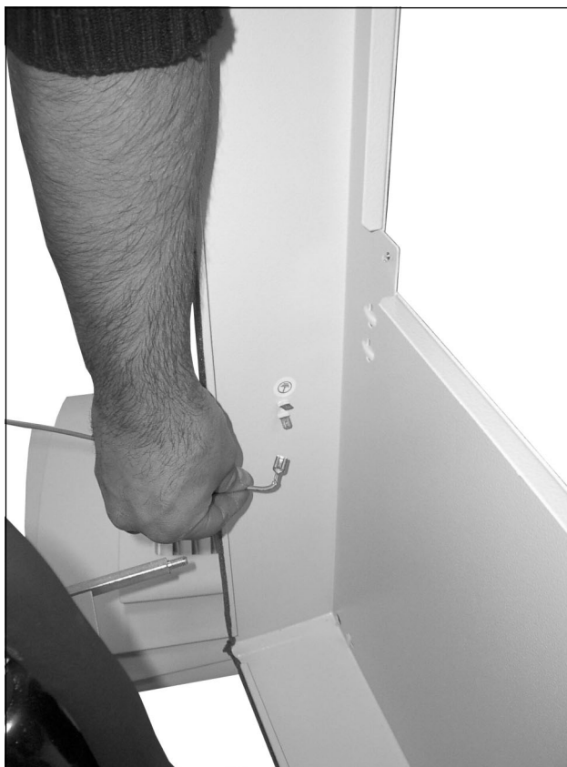
Bild 80: Dra ut jordningskabel (2)
