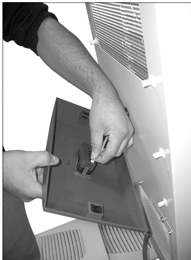
Bild 45: Koppla bort kontakt från displayen (1)
