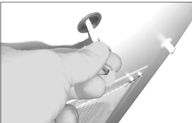
Bild 68: Sätt tillbaka displaykabeln och tryck genom kabelgenomföringen (1)
