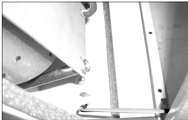
Bild 56: Lossa på jordningskabel mellan kåpa och chassi (1)
