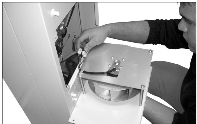
Bild 72: Dra bort fläktens kontaktförbindelser (1)
