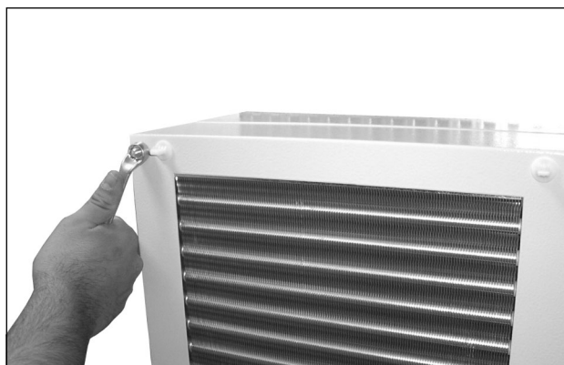
Bild 51: Montera bort kåpan (lossa på fyra skruvar)
