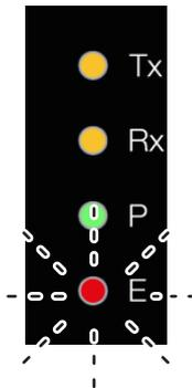
Die rote LED (E) des Moduls blinkt im Fehlerfall während des Betriebs in Intervallen von **0,5 s**.
