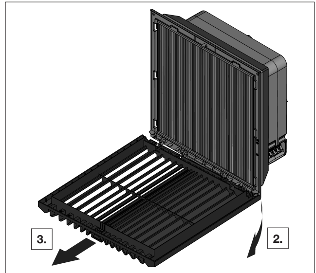
Afb. 4: Scharnier aan de rechterzijde van het ventilatiooster losnemen en ventilatiooster verwijderen
