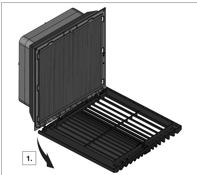
Fig. 3 : détacher le côté gauche de la charnière de la grille à lamelles
