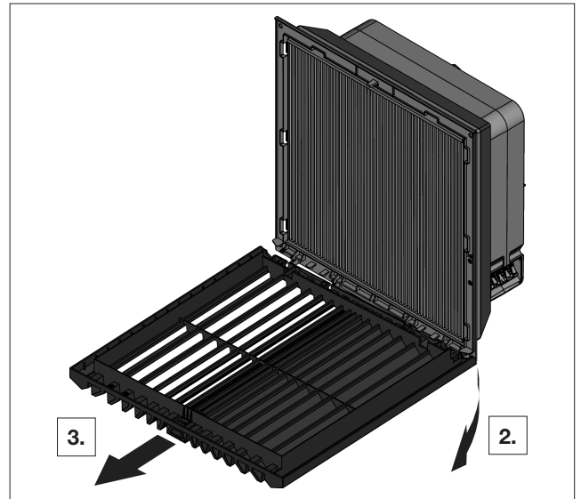
Fig. 4 : détacher le côté droit de la charnière et retirer la grille à lamelles
