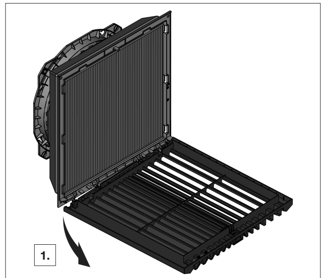
Fig. 5 : détacher le côté gauche de la charnière de la grille à lamelles (3239.xxx jusqu'à 3244.xxx)
