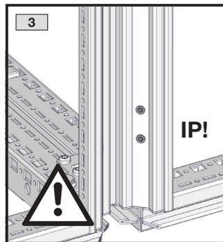
Für IP Schutz: Offene Gewinde-löcher sind mit Stopfen zu verschließen.
