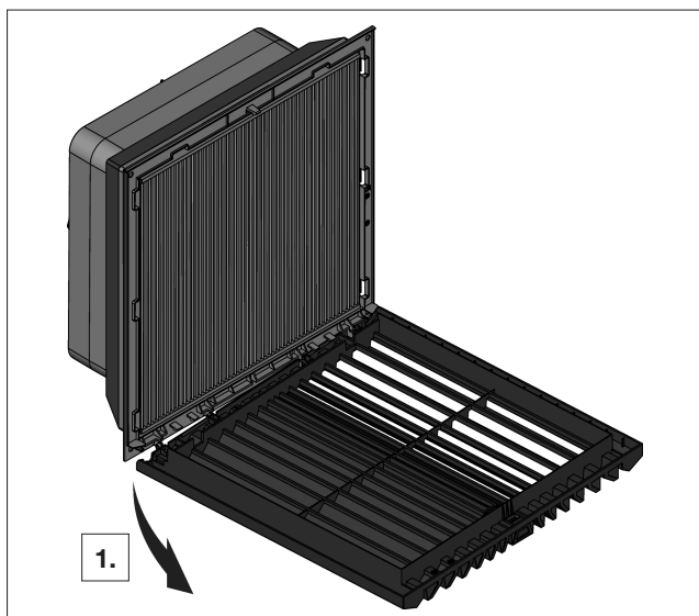
Obr. 3: Uvolněte levou stranu závěsu lamelové mřížky
