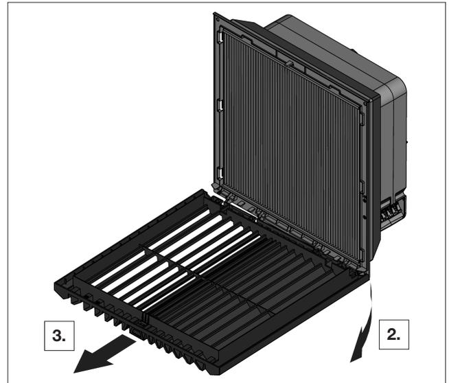
図4: 右側ヒンジを外し、ルーバーグリルを引き抜く
