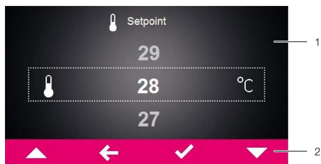
Fig. 23 : écran lors de la modification de la valeur d'un paramètre
