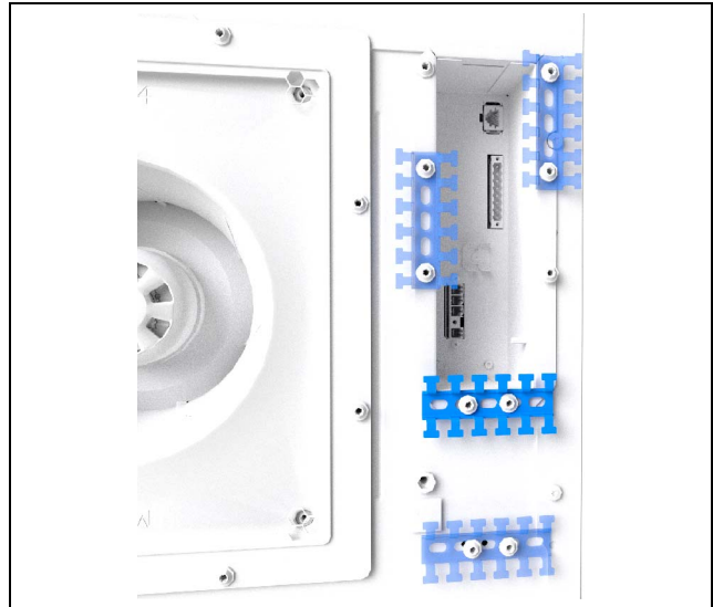
Afb. 19: Bevestiging van het C-profiel (voorbeeldweergave)
