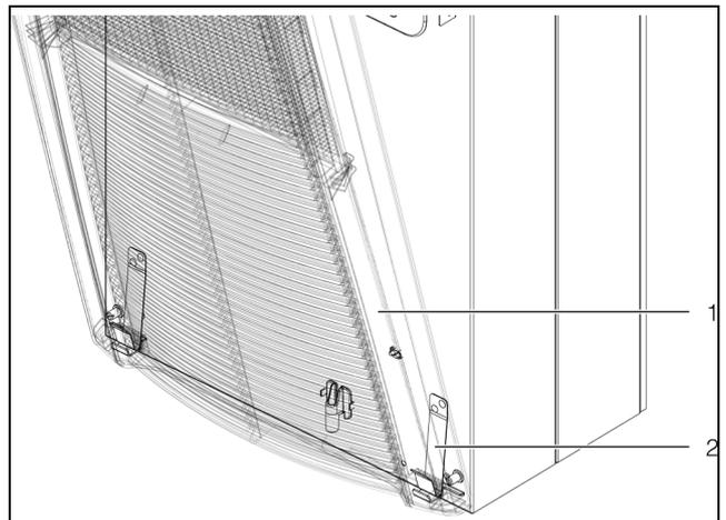
Imagen 31: Soportes inferiores de la rejilla (imagen de ejemplo)
