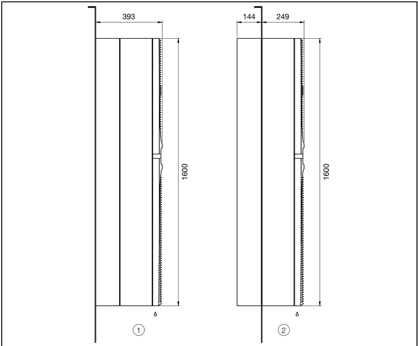
Imagen 43: Dimensiones SK 3188x4x y SK 3189x4x
