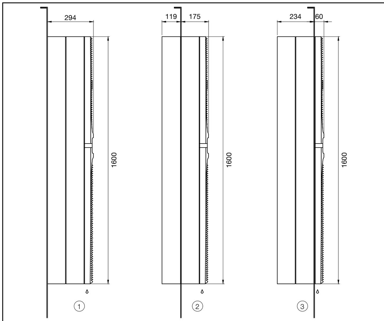
Imagen 42: Dimensiones SK 3186x3x y SK 3187x3x
