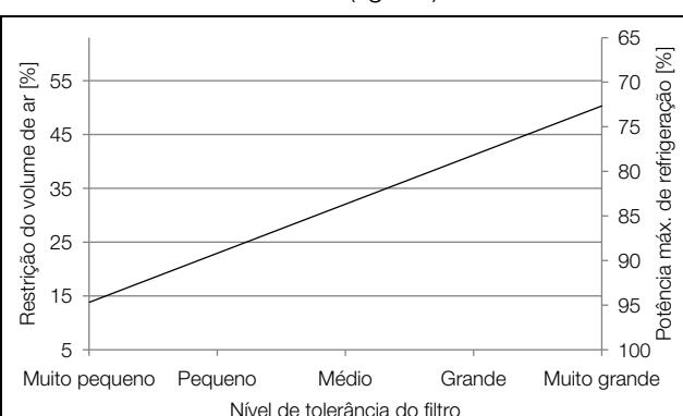
Fig. 21: Exemplo de progressão da potência de refrigeração
