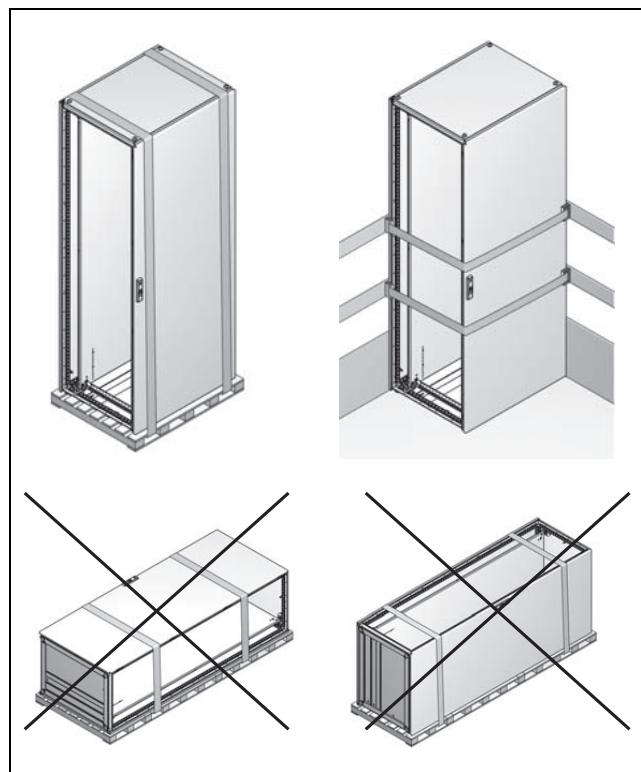
Fig. 5: Posições permitidas e proibidas para transportar a solução de integração
