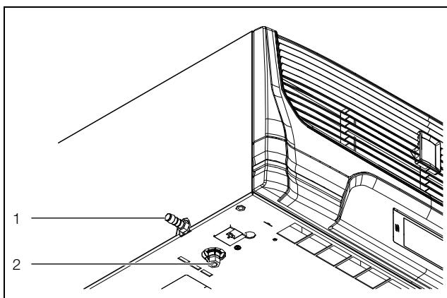
Fig. 10: Conexão da mangueira de água condensada
