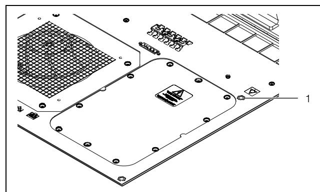
Fig. 14: Ponto de conexão da ligação equipotencial
