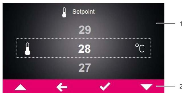
Fig. 19: Tela para modificação do valor de um parâmetro
