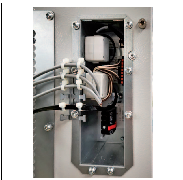
イラスト 33: フェライトコアの取り付け箇所 (SK 3186330、SK 3187330、SK 3188340、SK 3189340 の場合)
