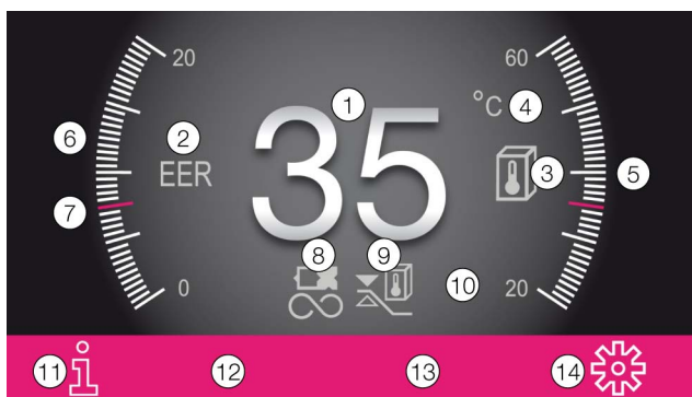
Fig. 41: Struttura della schermata iniziale
