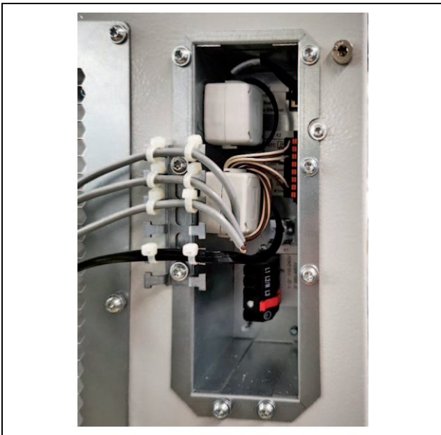
Obr. 33: Upevňovací bod pro feritové jádro na SK 3186330, SK 3187330, SK 3188340, SK 3189340
