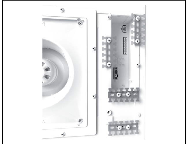
图片 39: 安装平底轨 (示例图)
