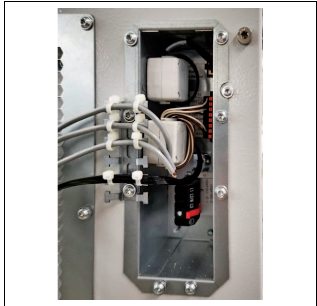
Bild 33: Ferritkärnans montagepunkt för SK 3186330, SK 3187330, SK 3188340 och SK 3189340
