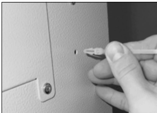
Obr. 18: Montáž kabelové spony pro odlehčení tahu na přední polovině skříňky chladicího modulu
