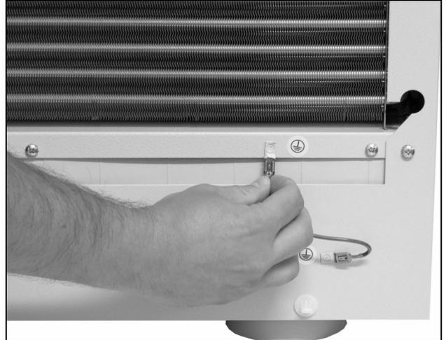
Abb. 27: Erdungskabel abziehen
