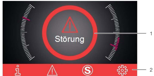
Abb. 47: Bildschirm bei Auftreten einer Störung
