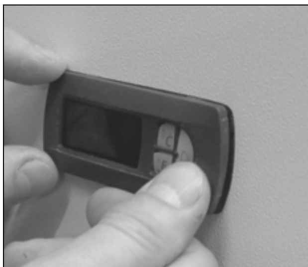
Imagen 12: Colocación de la tapa
