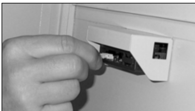
Fig. 15 : Brancher le câble de raccordement de l'afficheur
