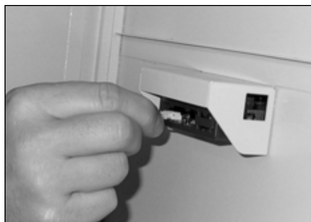
Fig. 28 : Ôter le connecteur de l'afficheur
