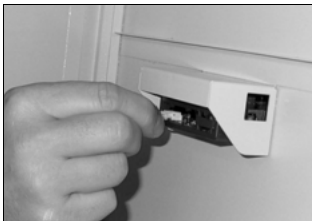
Kuva 15: Näytön liitäntäkaapelin kytkeminen
