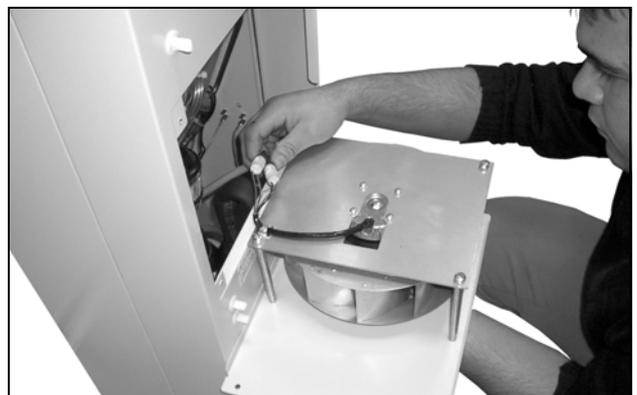
Abb. 65: Steckverbindungen des Lüfters abziehen (1)
