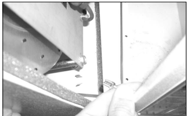
Abb. 50: Erdungskabel zwischen Haube und Chassis lösen (2)
