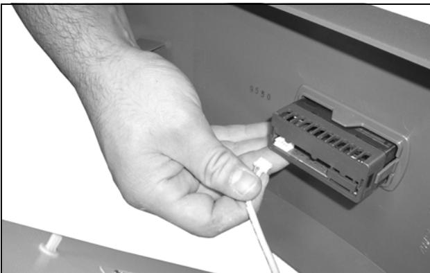
Abb. 60: Displaykabel abziehen
