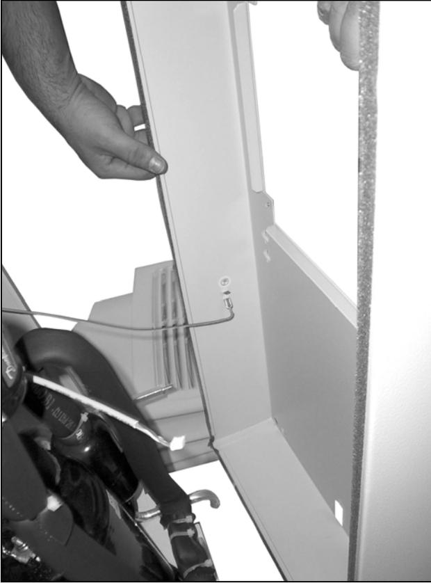
Abb. 72: Erdungskabel abziehen (1)
