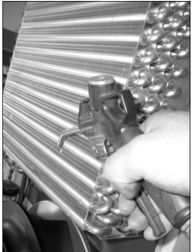
Abb. 75: Wärmetauschregister und Kompressorraum mit Druckluft ausblasen (2)
