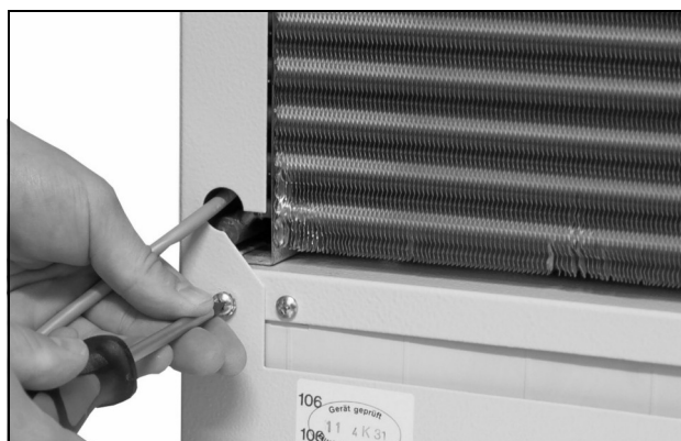
Obr. 28: Odstranění upevňovacích šroubů krytu (uvolnění čtyř šroubů)
