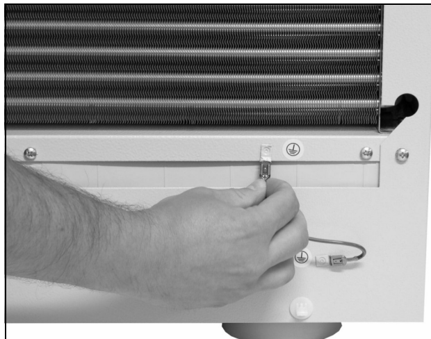
Obr. 27: Odpojení uzemňovacího kabelu
