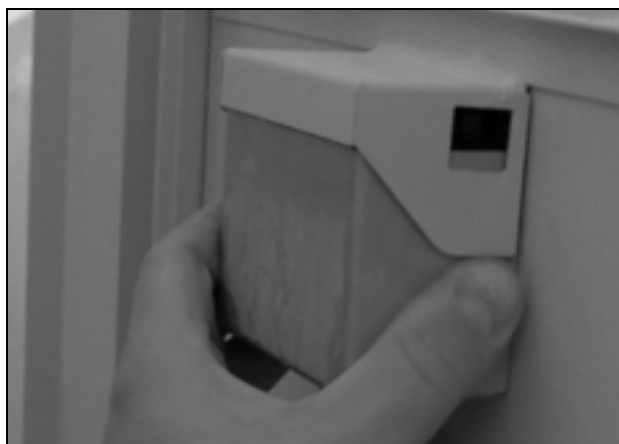
Fig. 14: Asportazione della copertura
