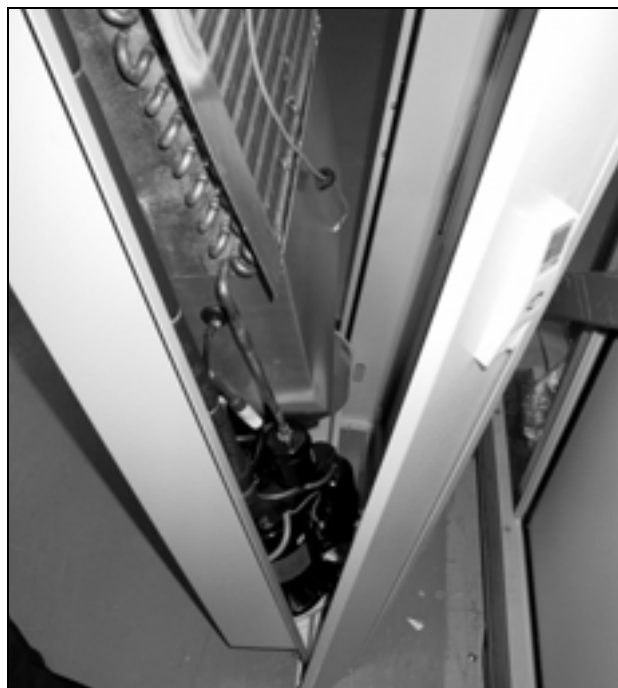
Fig. 8: Montaggio dell'unità clima nel carter porta
