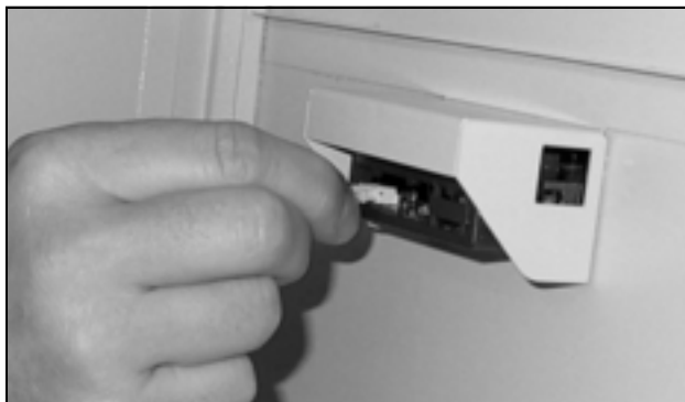
Fig. 15: Collegamento del cavo del display
