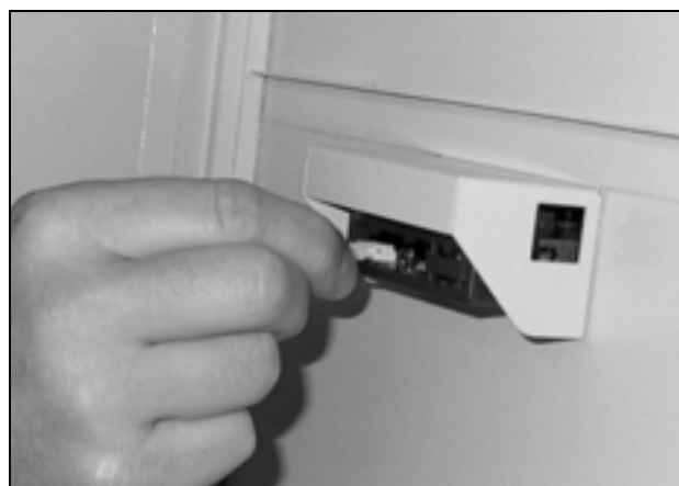
Fig. 28: Estrarre il connettore del display
