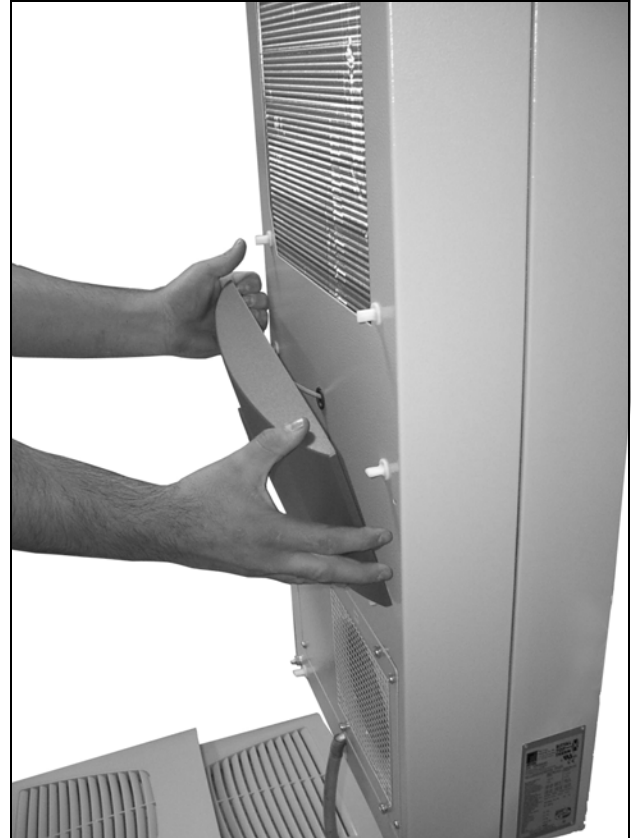
Fig. 37: Remove the infill panel
