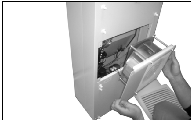
Fig. 64: Remove the external circuit fan
