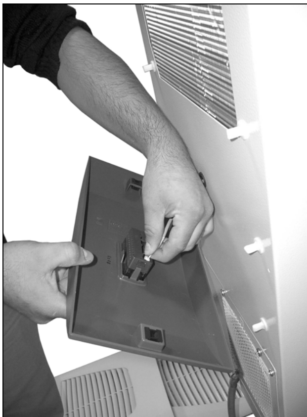
Fig. 38 : ôter le connecteur de l'afficheur (1)
