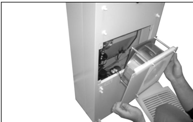
Fig. 64 : démonter le ventilateur du circuit externe
