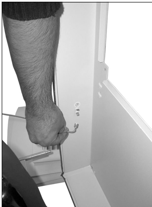
Fig. 73 : retirer le câble de mise à la masse (2)
