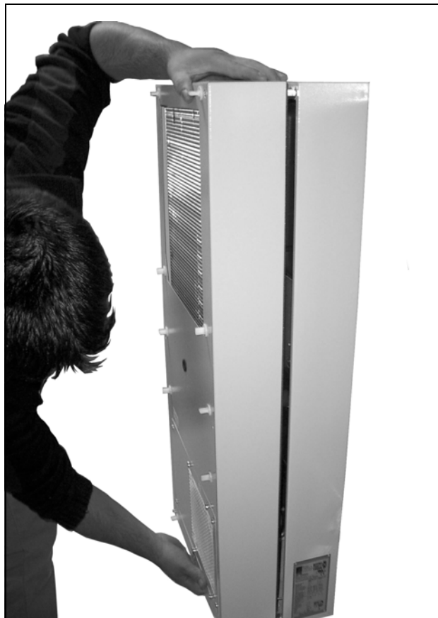
Fig. 47 : retirer le capot (1)
