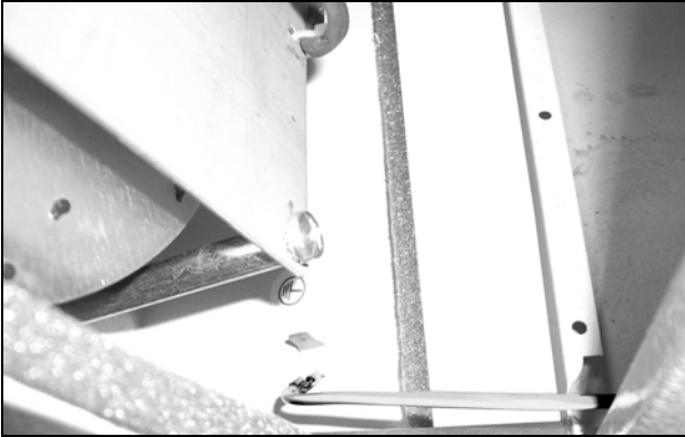
Fig. 49 : retirer le câble de mise à la terre qui se trouve entre le capot et le châssis (1)
