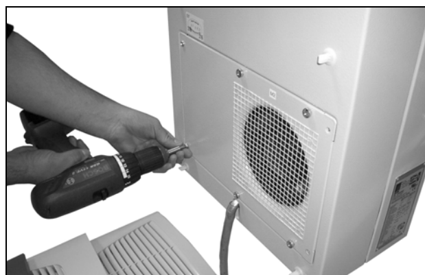
Fig. 41 : démonter le ventilateur du circuit externe (4 vis à dévisser)
