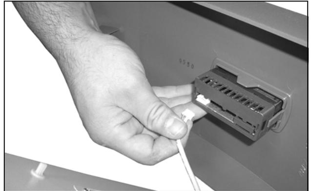
Fig. 60: Estrarre il cavo del display
