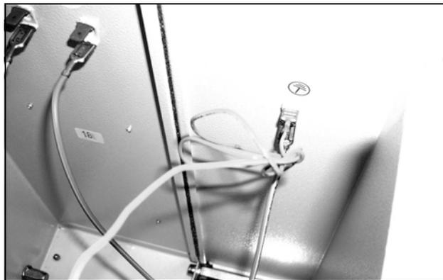
Fig. 68: Scollegare il cavo di massa del ventilatore (1)
