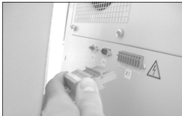
Fig. 53: Estrarre il connettore di alimentazione
