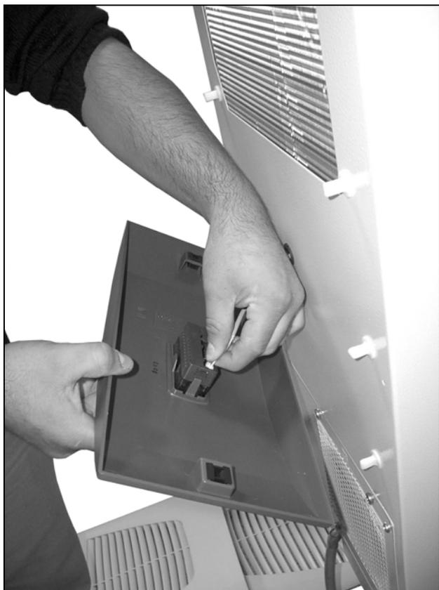
Fig. 38: Estrarre il connettore del display (1)
