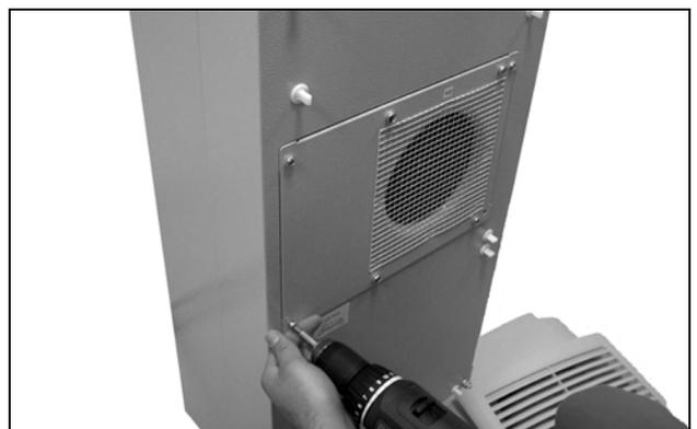
Fig. 63: Allentare le quattro viti del ventilatore del circuito esterno
