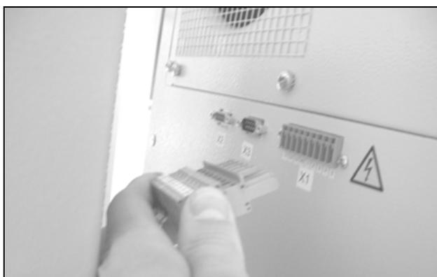
Fig. 34: Estrarre il connettore di alimentazione
