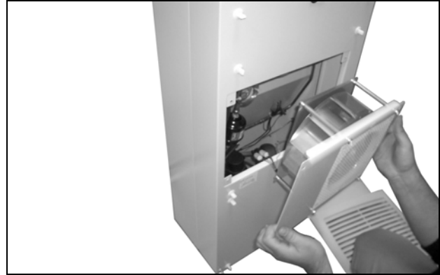
64. ábra: Szerelje ki a külső kör ventilátorát
