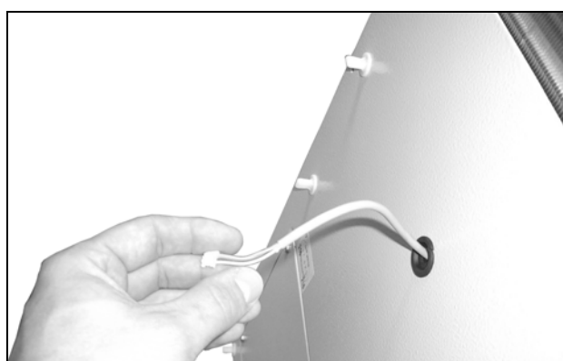
45. ábra: Tolja vissza a kijelző kábelét
