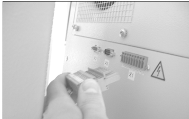
34. ábra: Húzza ki a hálózati csatlakozót
