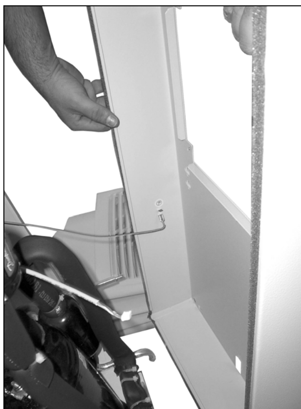
72. ábra: Húzza ki a földelőkábelét (1)
