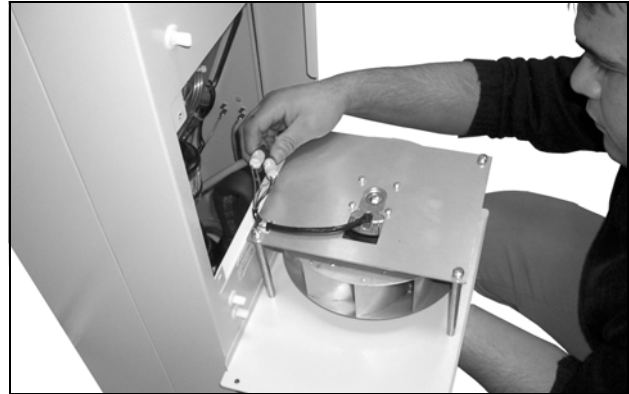
65. ábra: Húzza ki a ventilátor csatlakozódugóit (1)
