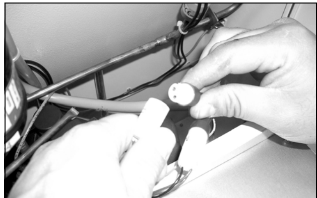
67. ábra: Húzza ki a ventilátor csatlakozódugóit (3)
