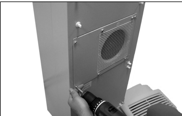
63. ábra: Lazítsa le a külső kör ventilátorának négy csavarját
