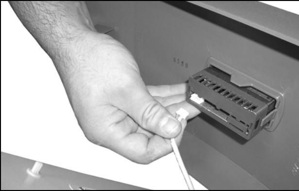
60. ábra: Húzza ki a kijelző kábelét
