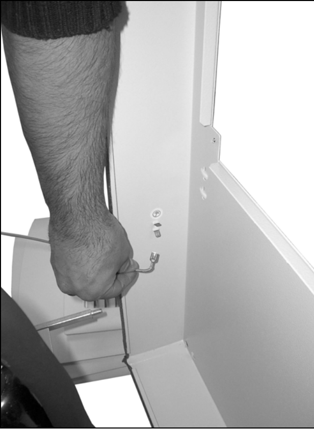
73. ábra: Húzza ki a földelőkábelt (2)
