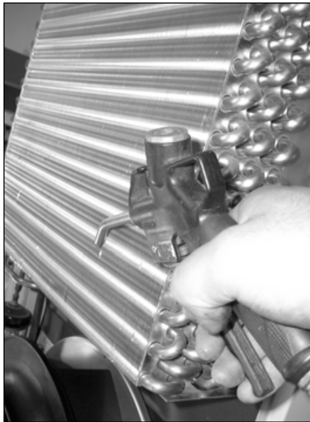
51. ábra: Fúvassa ki a hőcserélőt és a kompresszorteret sűrített levegővel (1)
