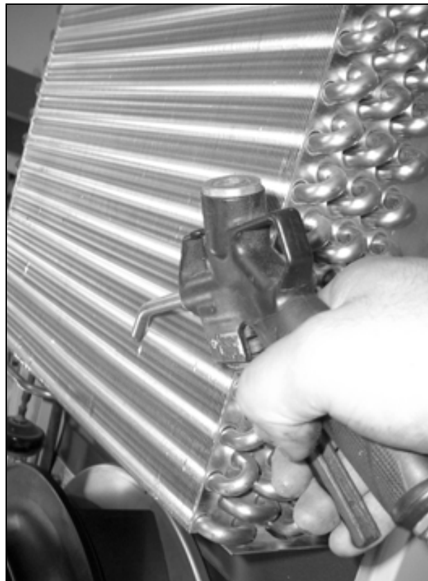
Obr. 51: Vyfúkanie telesa výmenníka tepla a priestoru kompresora stlačeným vzduchom (1)
