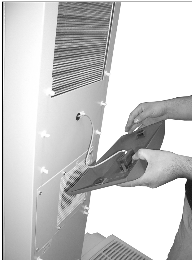
Obr. 59: Demontáž čelného modulu
