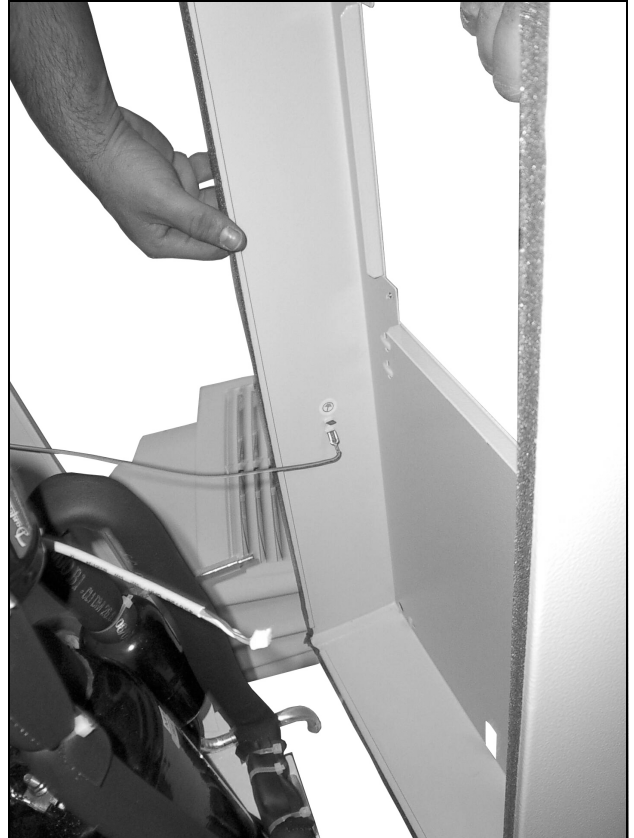
Obr. 72: Odpojenie zemniaceho kábla (1)
