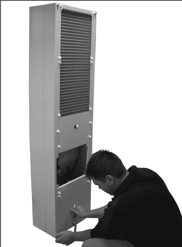
Obr. 70: Povolenie štyroch skrutiek krytu
