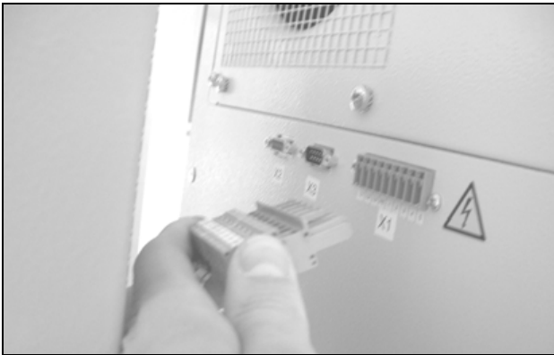
Obr. 34: Vytiahnutie sieťovej zástrčky
