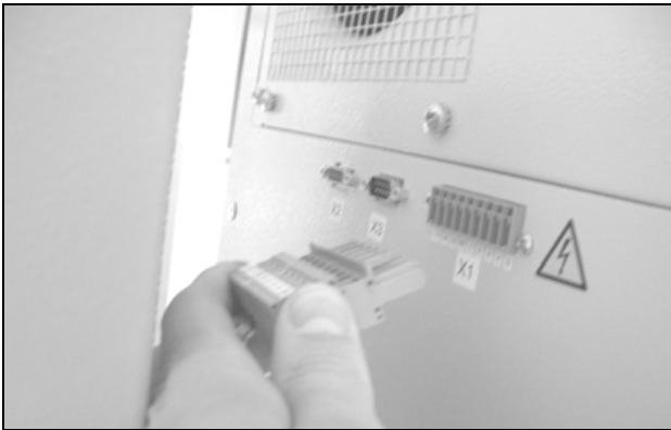
Obr. 53: Vytiahnutie sieťovej zástrčky
