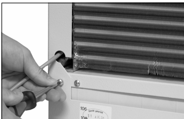
Fig. 28: Rimuovere le viti di fissaggio della cuffia (allentare quattro viti)
