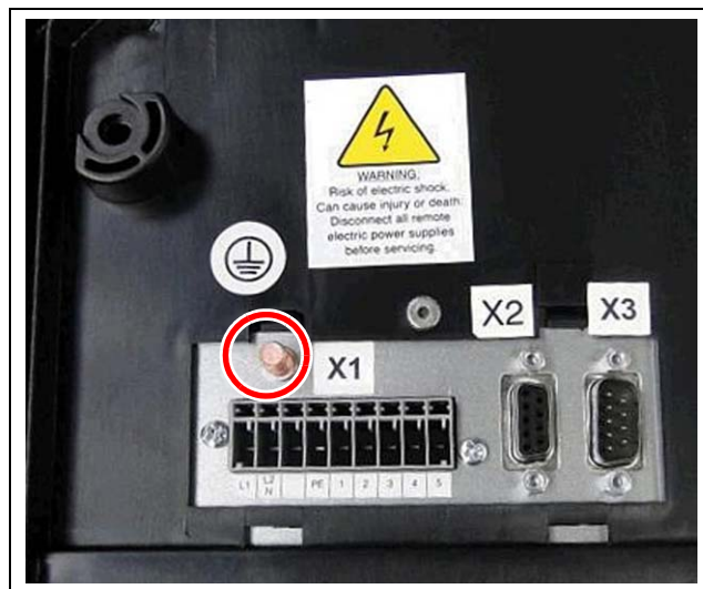
Fig. 13: Punto di connessione della compensazione del potenziale
