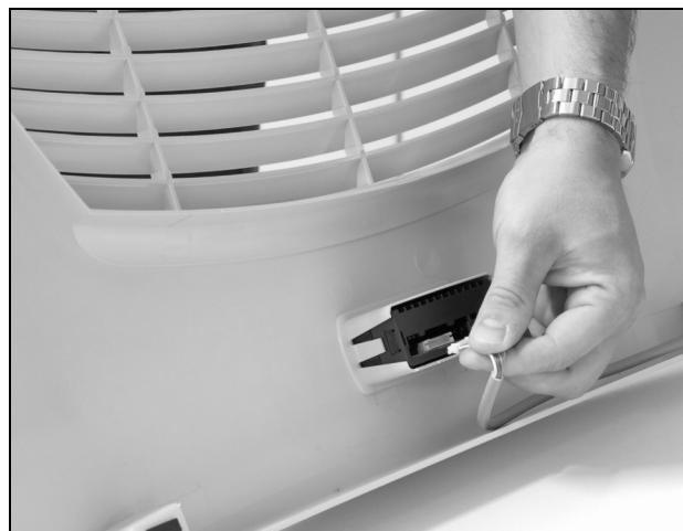
Rys. 26: Odłączanie wtyczki od wyświetlacza
