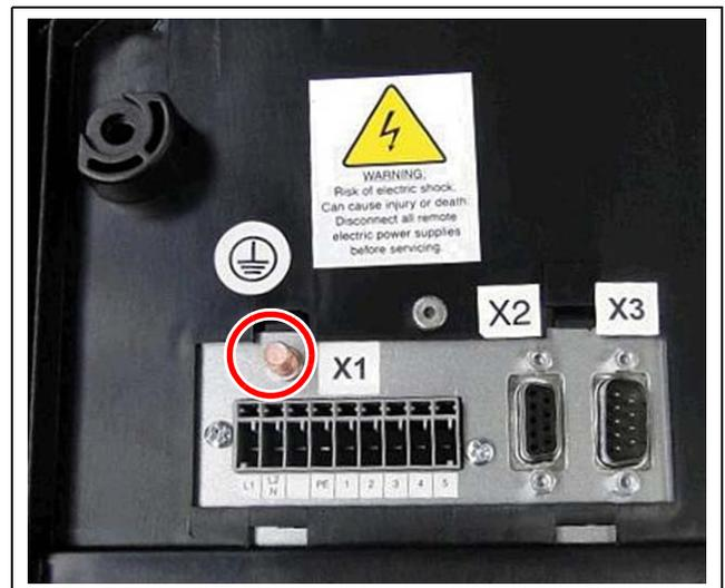
Fig. 13: Ponto de conexão, potencial de equalização
