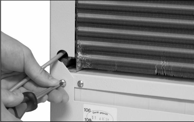
Fig. 28: Retirar os parafusos de fixação da tampa (soltar os quatro parafusos)
