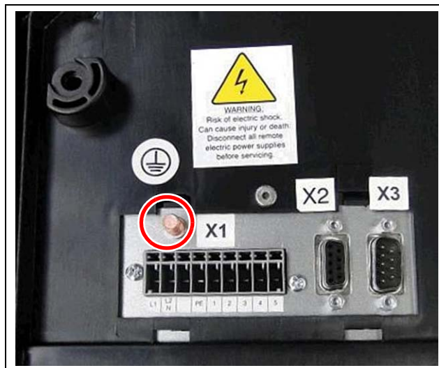
Fig. 13 : plot de mise à la masse
