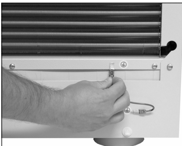
Fig. 27 : ôter le câble de mise à la masse
